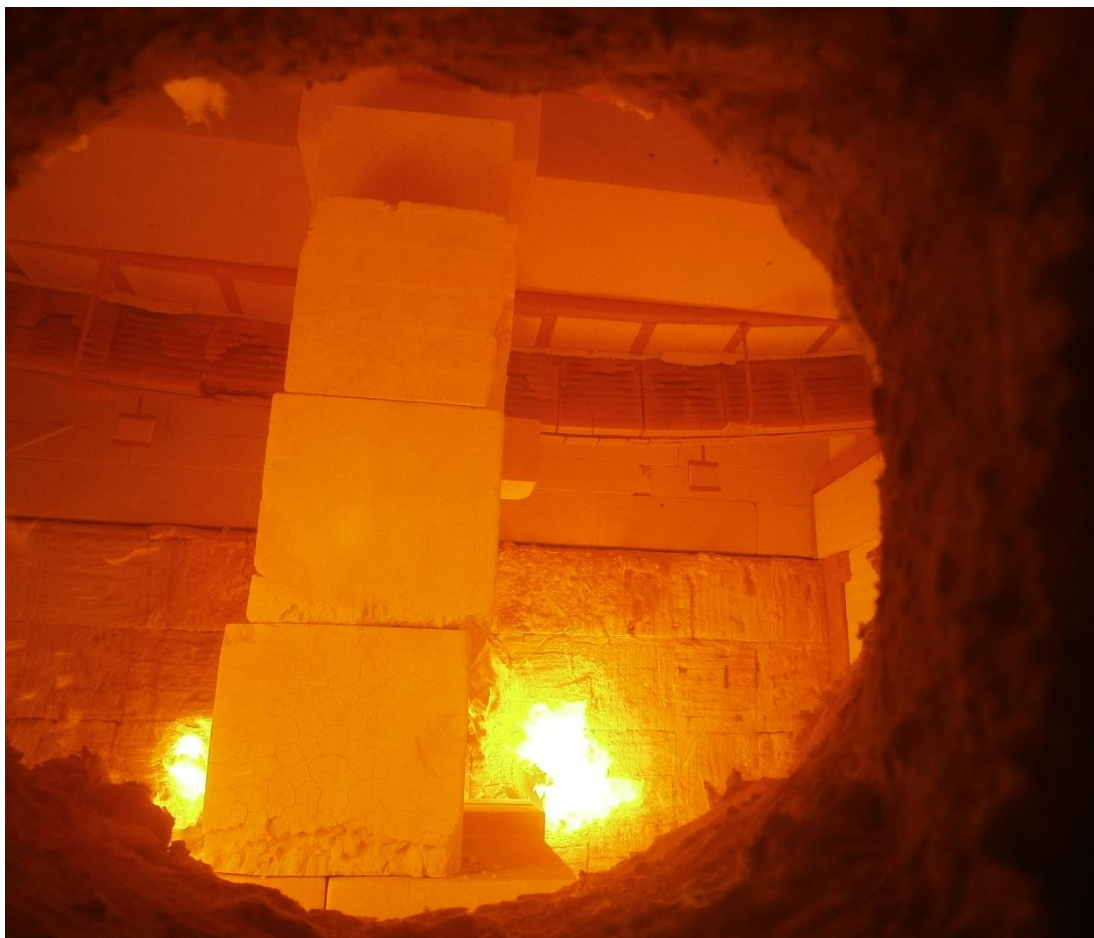
Obrázek 38 – Vzorek v peci po dosažení limitního kritéria [14]
