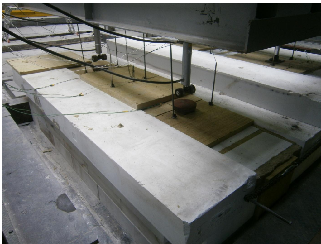
Obrázek 37 – Zatížení zkušební vzorku simulované osamělými břemeny [14]
