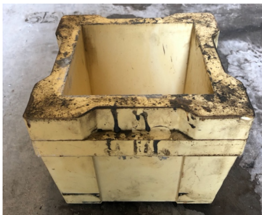
Obrázek 16: Formy pro krychle – betonárna
