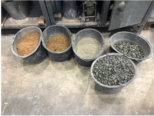
Obrázek 9: Navážené složky betonu
