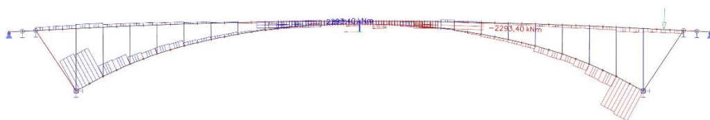
Obrázek 28: Průběh krouticího momentu od vlastní tíhy oblouku.
