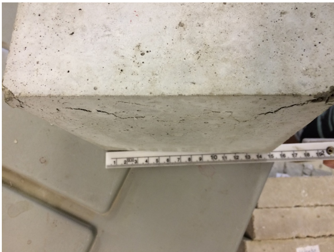
Obrázek 40 Ukázka betonu po zatížení při - 15 °C
