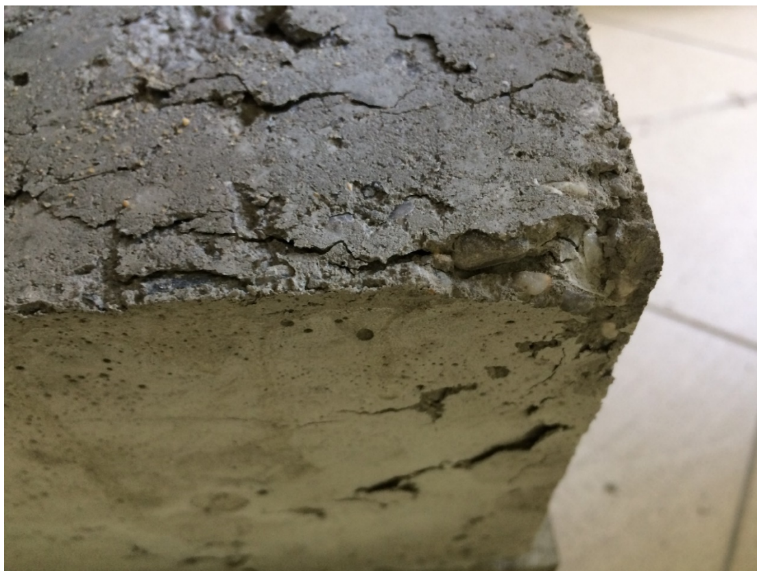
Obrázek 42 Ukázka betonu po zatížení – odloupení rohu - 20 °C
