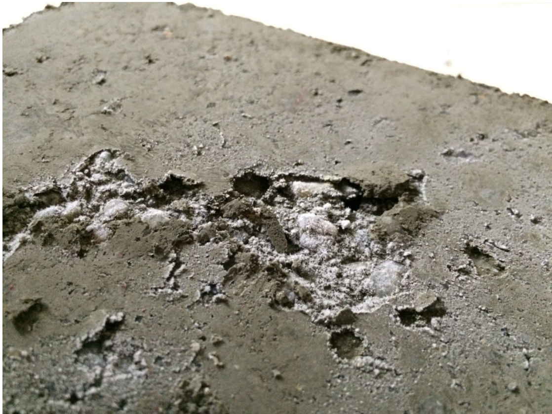
Obrázek 31 Detail porušení povrchu po zatěžovací zkoušce - 20 °C
