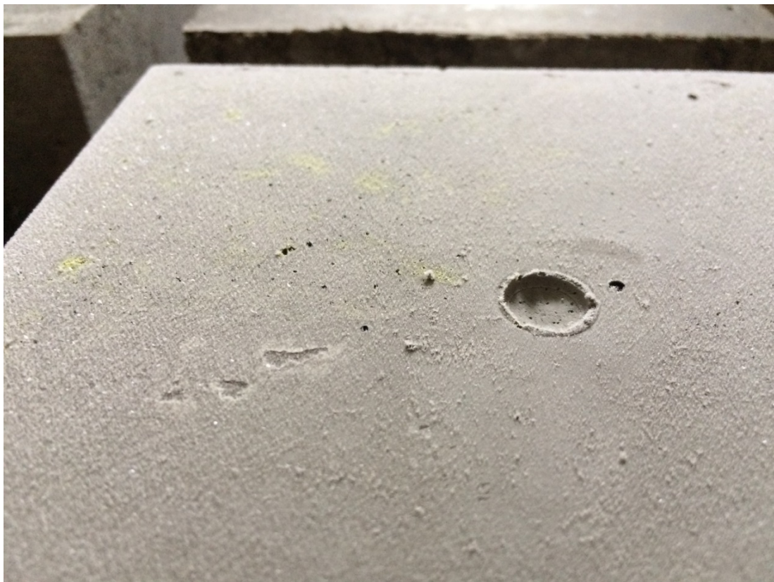
Obrázek 28 Zmrzlý vzorek při teplotě - 20 °C
