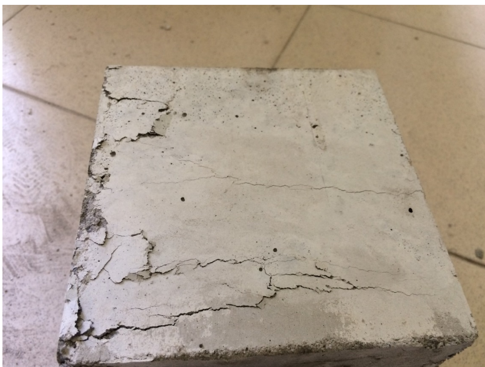
Obrázek 26 Zničení vrchní vrstvy při teplotě - 15 °C
