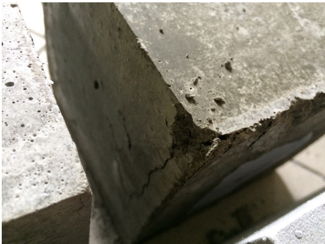
Obrázek 24 Samovolné odlamování při teplotě – 15 °C
