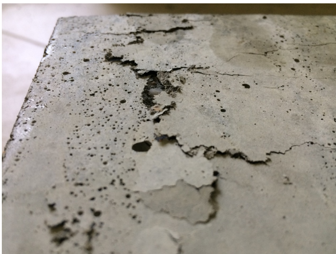
Obrázek 41 Ukázka betonu po zatížení – praskliny a odlupování - 15 °C
