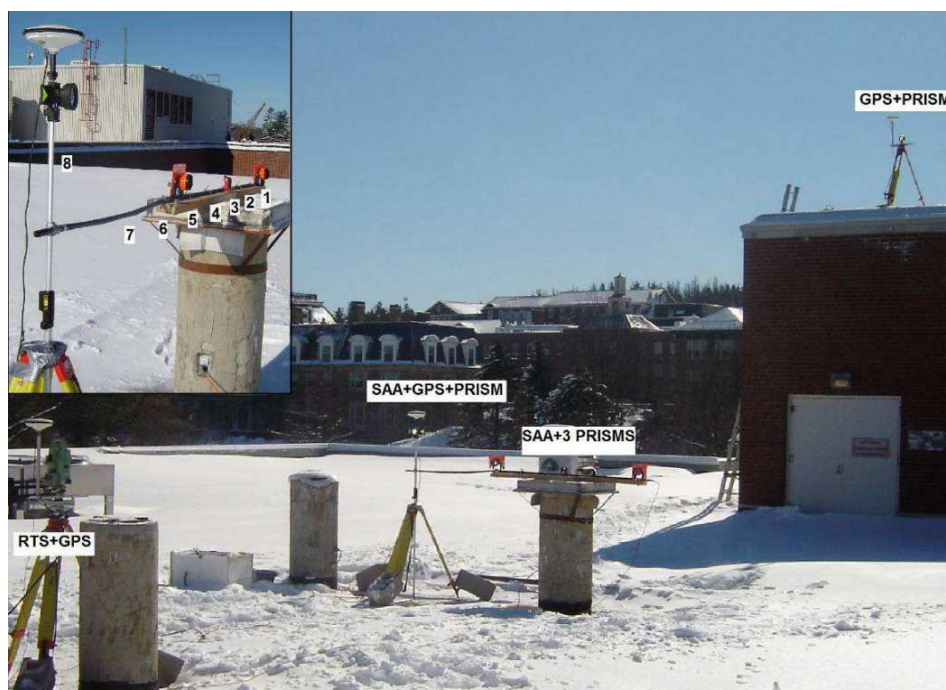
Obr. 3.14 Umístění jednotlivých zařízení během experimentu s SAA, RTS a GPS (Danisch et al. 2008)
