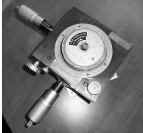
Obr. 4.4 Mikroposuv pro vyvolání horizontálních posunů
