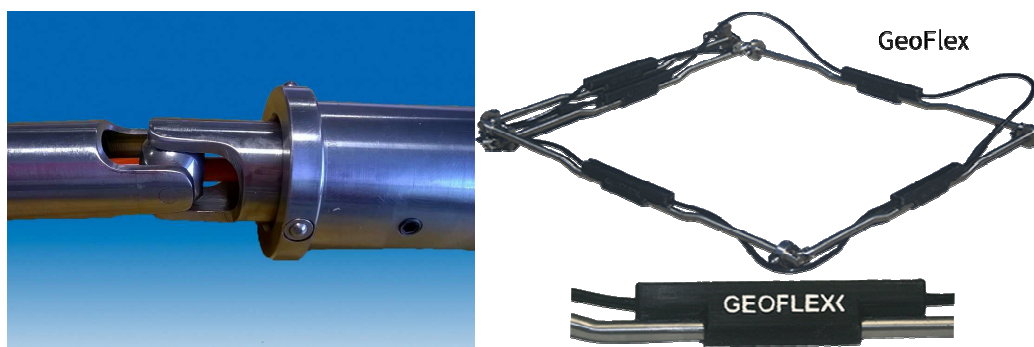
Obr. 2.4 IPI systém GeoFlex:(vlevo) Detail propojení jednotlivých segmentů; (vpravo) Sensorická část segmentu je zvnějšku umístěna na ocelovém profilu segmentu.
