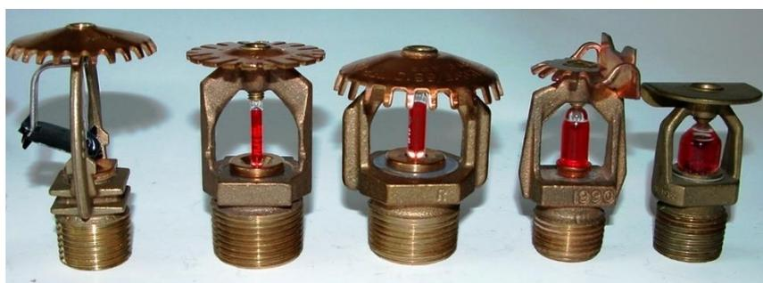
Obr. 9: 1-sprinkler-stojatý s tavnou poistkou; 2-závesný, 68 °C s rýchlou odozvou; 3-stojatý so špeciálnou odozvou; 4-horizontálny so štandardnou odozvou A; 5-stojatý stenový so štandardnou odozvou B. [5]
