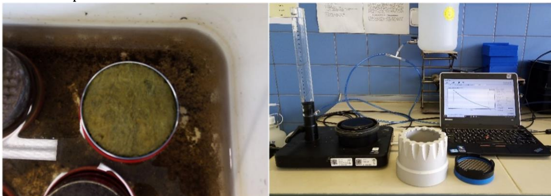
Obrázek 3.1 – vzorek minerální vlny a laboratorní sestava (Zdroj: vlastní archiv)
