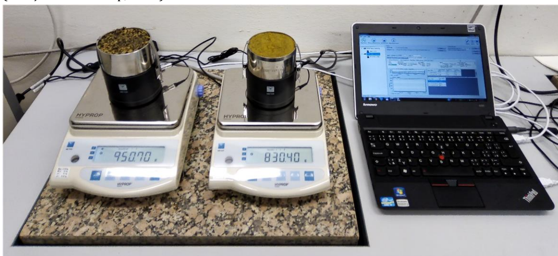
Obrázek 3.5 – sestava měřícího zařízení HYPROP včetně propojení s laptopem (Zdroj: vlastní archiv)
