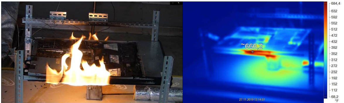
Obrázek 30 – 30:00 Zvýšení výkonu hořáku na 15 Kw
