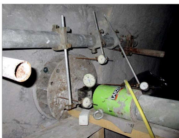
Obr. 16 a Obr. 17: Celkový pohled na sestavu rozpěrné zatěžovací zkoušky a detail zatěžovací desky s hydraulickým lisem, dynamometrem a hodinkovými deformometry
