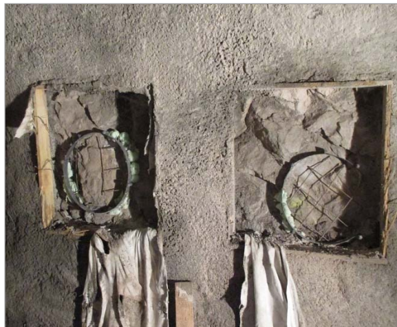
Obr. 12 a Obr. 13: Čtvercová okna v ostění štoly pro rozpěrné zatěžovací zkoušky před vyrovnáním stříkaným betonem
