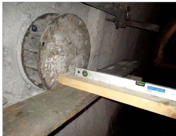
Obr. 14 a Obr. 15: Pohled na místo zkoušky po vyrovnání stříkaným betonem a osazenou zatěžovací desku
