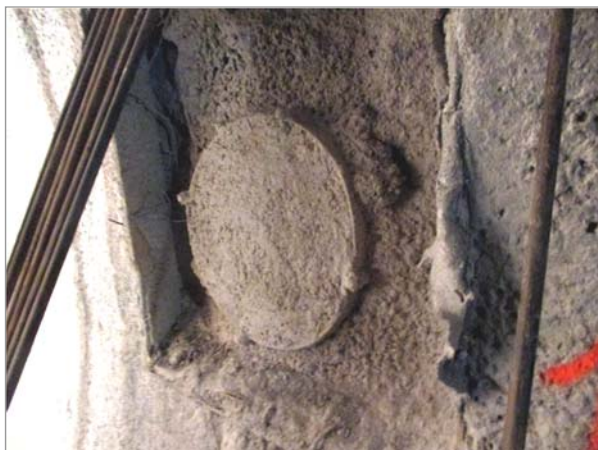
Obr. 14 a Obr. 15: Pohled na místo zkoušky po vyrovnání stříkaným betonem a osazenou zatěžovací desku
