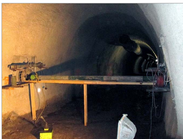
Obr. 16 a Obr. 17: Celkový pohled na sestavu rozpěrné zatěžovací zkoušky a detail zatěžovací desky s hydraulickým lisem, dynamometrem a hodinkovými deformometry
