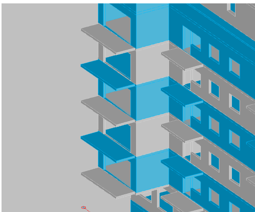
Obr. 36: Vykonzolovaná část objektu mezi osami 5 a 6
