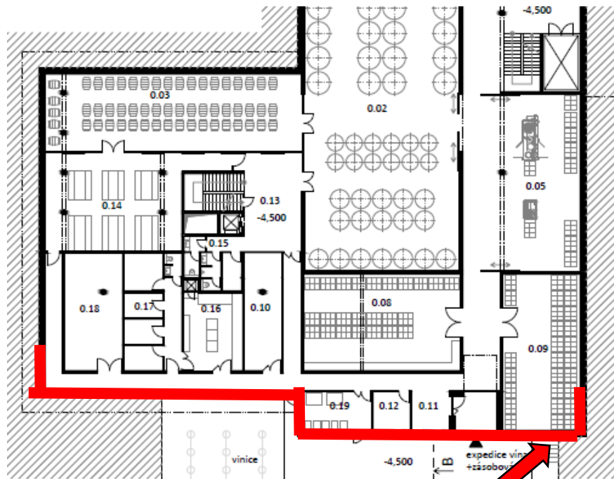
Obrázek 21: Základový práh pod základovou deskou v 1.PP [1]
