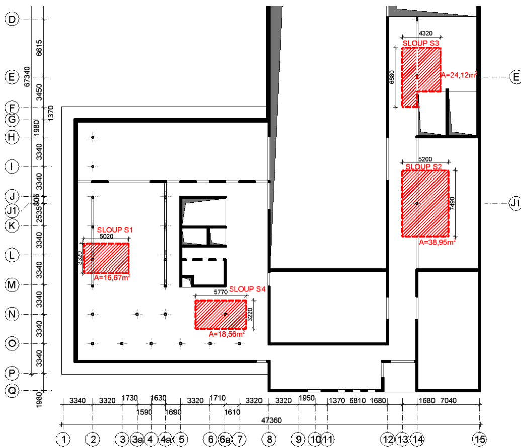
Obrázek 37: Vyznačení navrhovaných sloupů S1, S2, S3 a S4 v 1.PP
