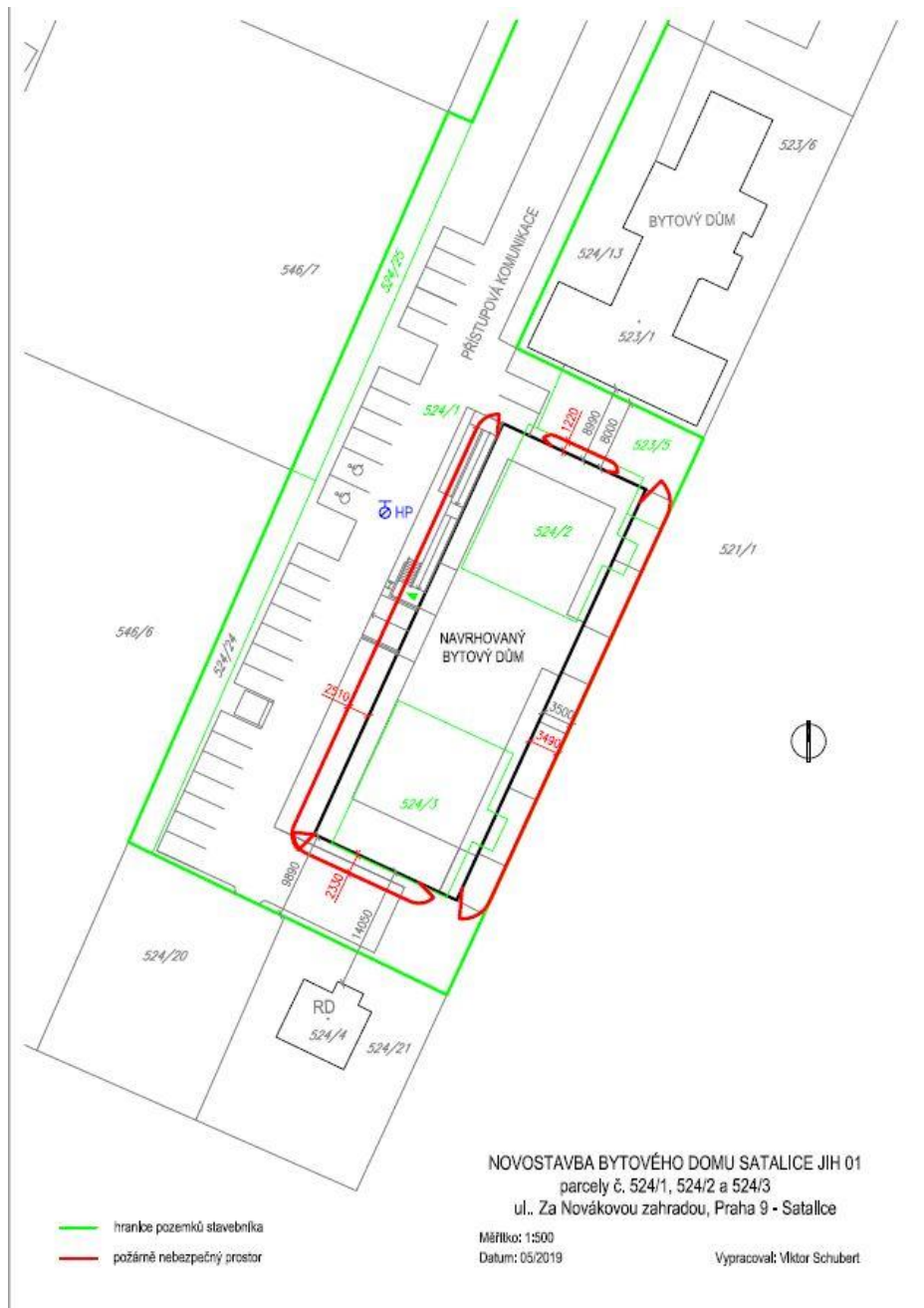
Obrázek 7: Situace požárně nebezpečného prostoru
