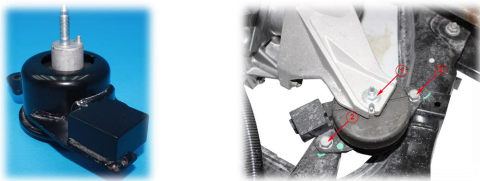
Obrázok 33: Konštrukčný detail uloženia elektrického pohonu Nissanu Leaef vpredu vľavo
