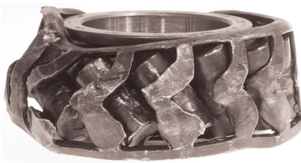
Obrázek 17 Poškození klece ložiska
