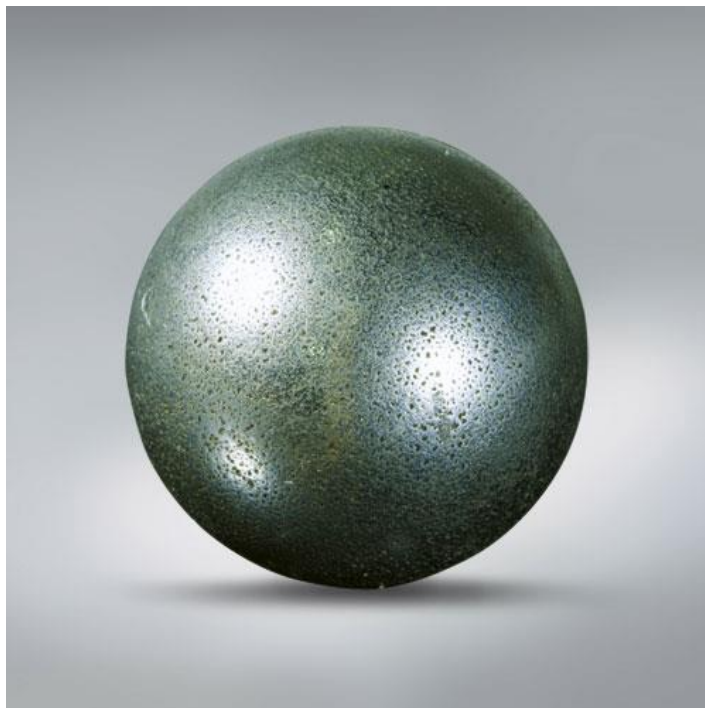
Obrázek 14 Pitting na valivém elementu
