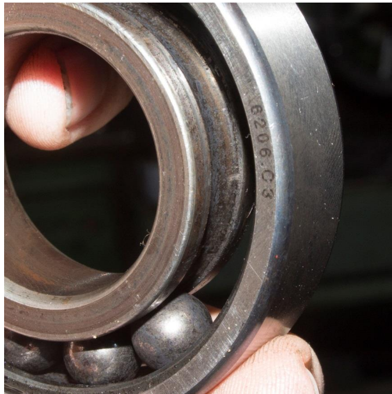
Obrázek 16 Koroze na ložisku
