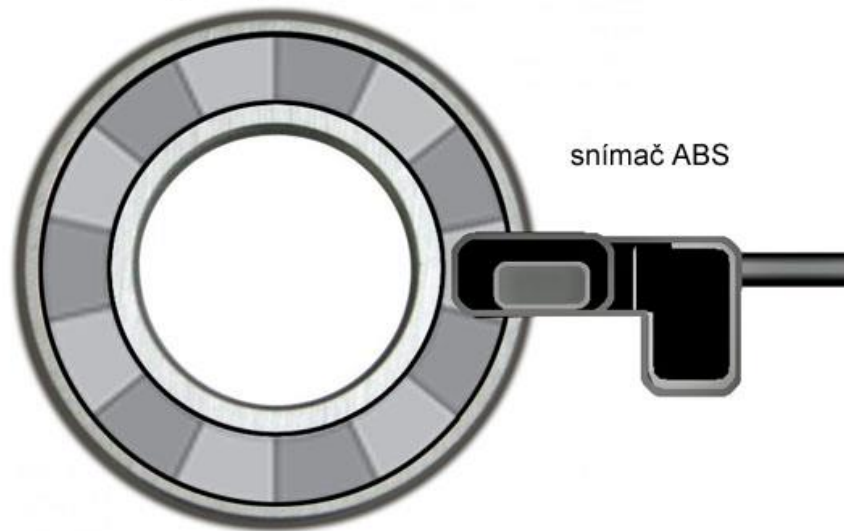
Obrázek 23 Sensor s magnetickým kroužkem
