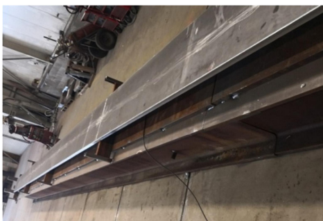
Obrázek 20: Uložení pásnice a přebroušení stykové plochy budoucího svaru – „pásnice X stojina“
