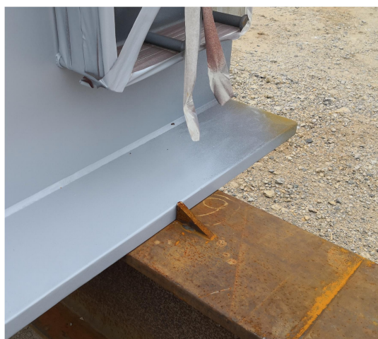
Obrázek 34: Uložení dílců na venkovní přípravek – spasování s respektováním mezery pro finální svar
