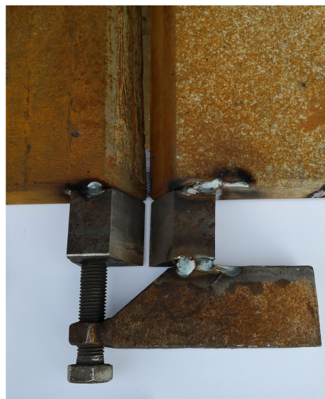
Obrázek 35: spasování dílců nosníku s pomocí montážní pomůcky – zajištění správné mezery pro finální svar
