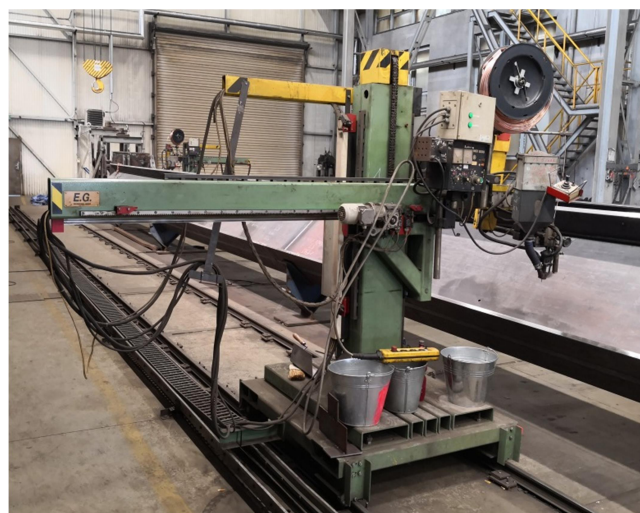
Obrázek 25 b: Provedení svaru automatickým svařováním pod tavidlem
