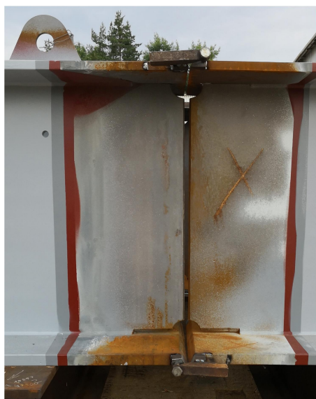
Obrázek 35: spasování dílců nosníku s pomocí montážní pomůcky – zajištění správné mezery pro finální svar
