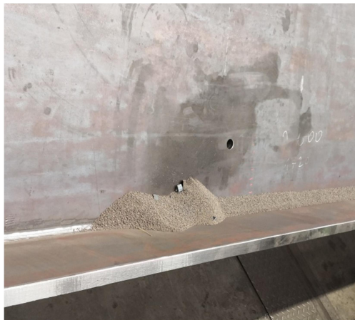
Obrázek 28: Svar ve stadiu – odstraňování strusky + hotový svar
