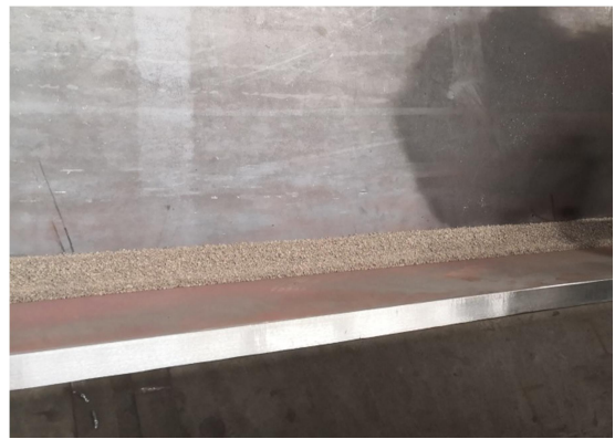
Obrázek 27: Svar ve stadiu – nastehováno + zasypáno tavidlem
