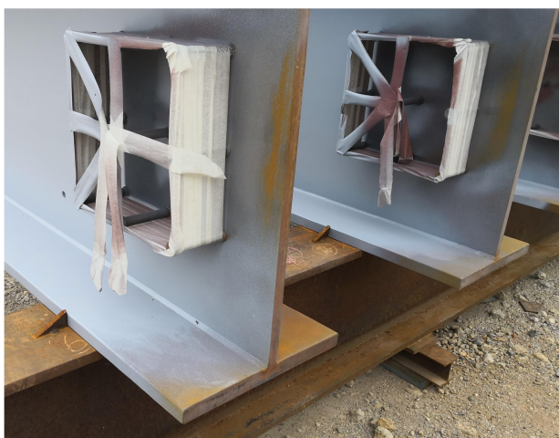
Obrázek 34: Uložení dílců na venkovní přípravek – spasování s respektováním mezery pro finální svar
