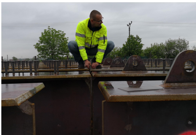
Obrázek 34: Uložení dílců na venkovní přípravek – spasování s respektováním mezery pro finální svar
