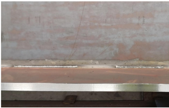
Obrázek 27: Svar ve stadiu – nastehováno + zasypáno tavidlem
