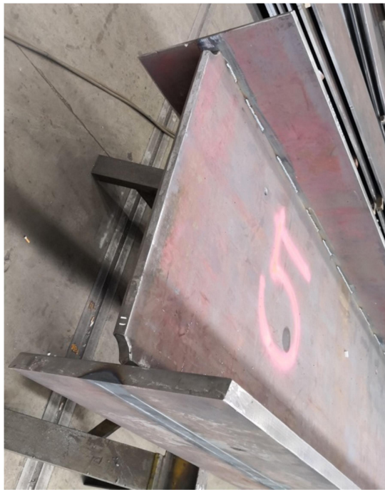
Obrázek 22: Sestehování I profilu – „pásnice X stojina X pásnice“
