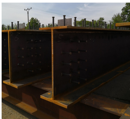
Obrázek 33: Uložení dílců na venkovní přípravek – pro měření rozměrů a tvarových odchylek
