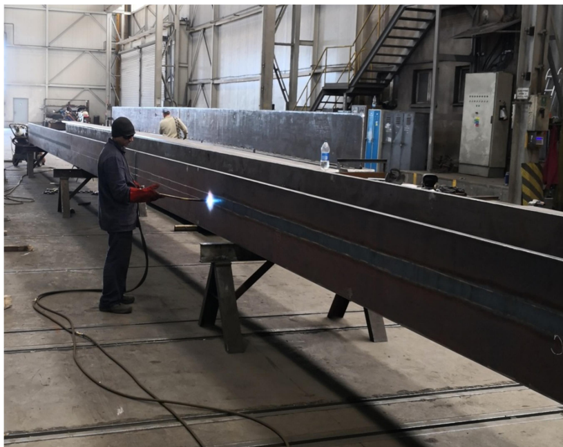
Obrázek 23: Předehnutí nastehovaného I profilu – ohřev – kyslíko-acetylénovým plamenem
