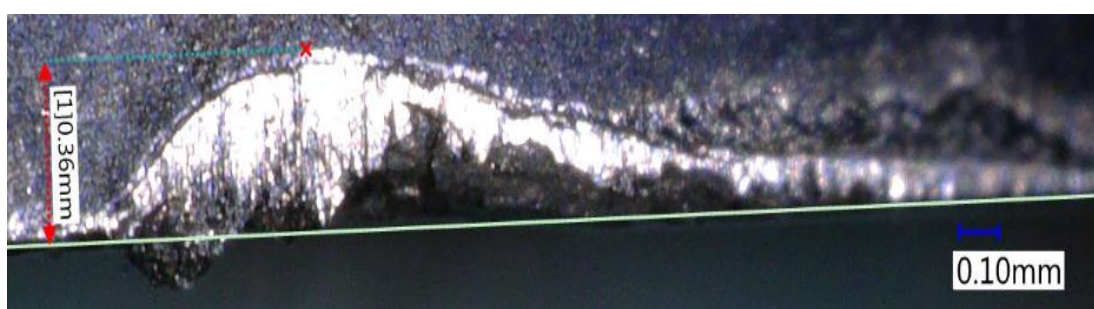
Obrázek 45 opotřebení destičky při posuvu 0,12 mm s úhlem čela 13,5^\circ
