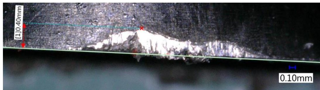
Obrázek 38 opotřebení destičky při posuvu 0,08mm s úhlem čela 0^\circ
