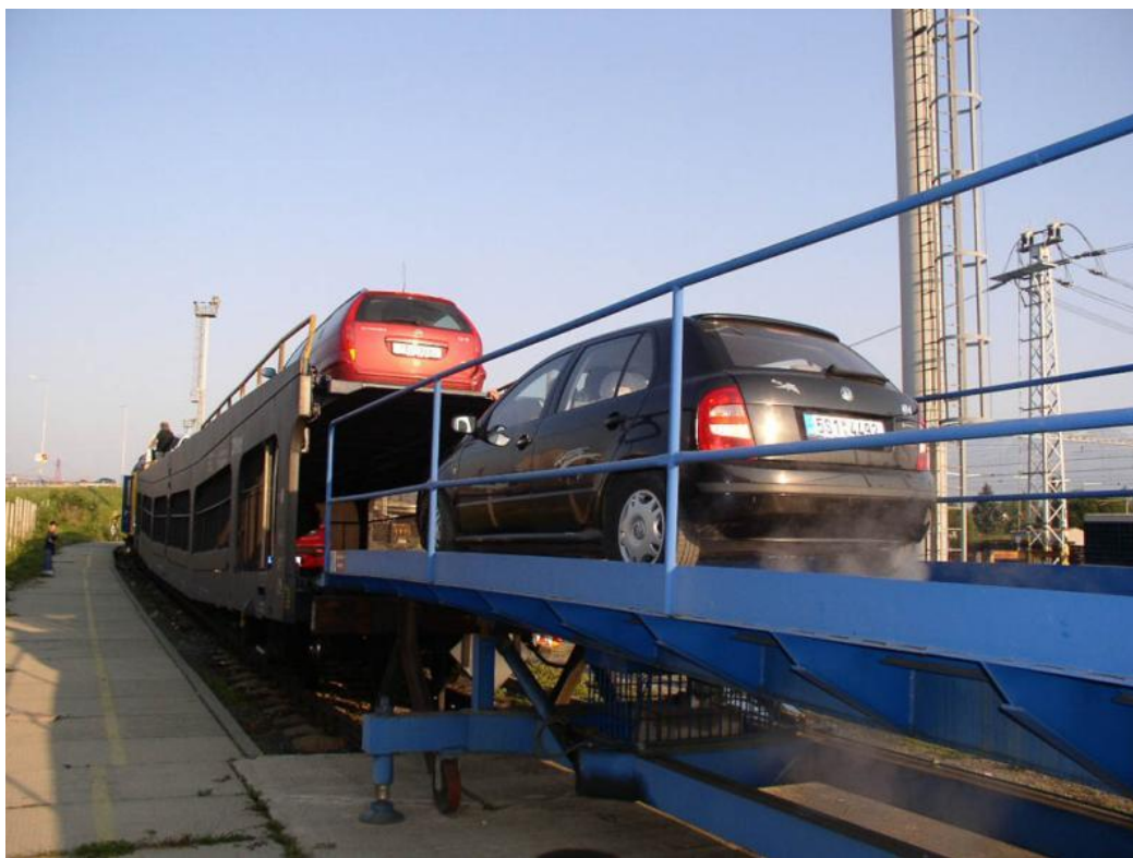
Obrázek 1: Čelní nakládka pomocí výškově stavitelné jednopodlažní rampy [35]
