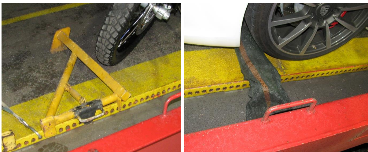
Obrázky 17 a 18: Vlevo běžná zarážka na voze DDm, vpravo vak pro auta s nízkým podvozkem [zdroj autor]
