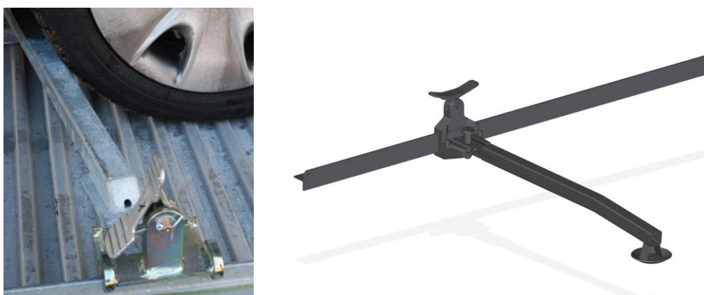
Obrázky 21 a 22: Vlevo zarážka autovozu Laaers 700 v jistící poloze [30], vpravo 3D model zarážky [31]
