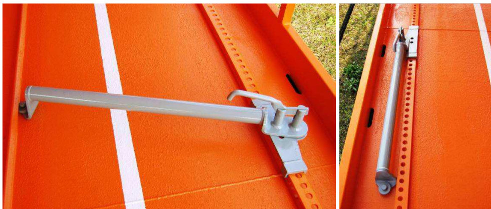
Obrázky 19 a 20: Vlevo zarážka autovozu Laaers 560 v jistící poloze, vpravo v poloze nejistící [29]
