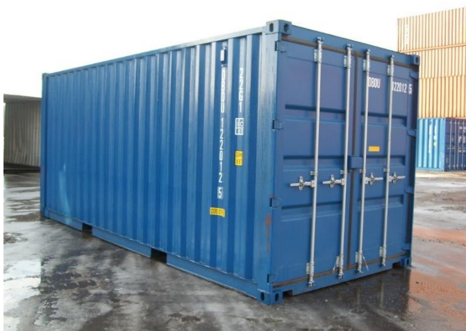
Obrázek 14. 20 stopy kontejner ISO 668.
