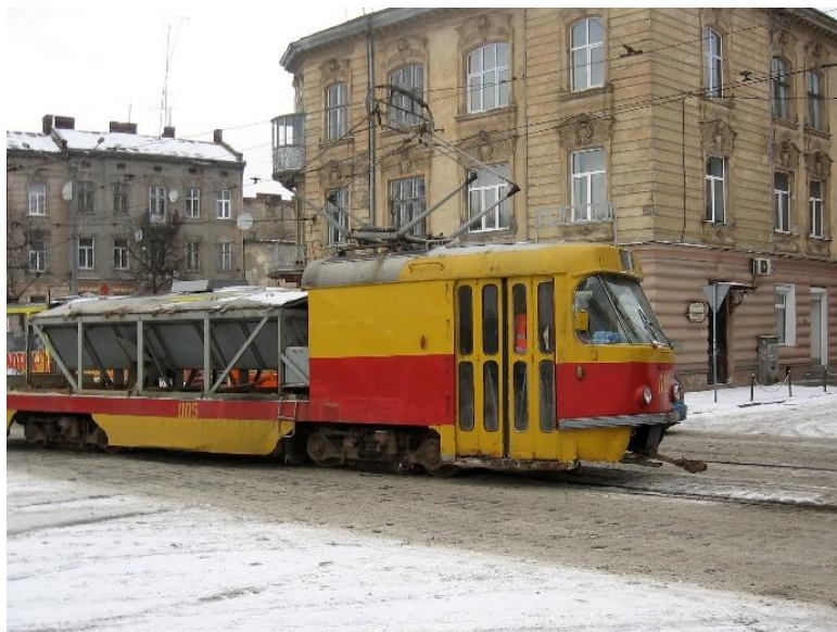
Obrázek 7. Tatra T3 přestavěná na nákladní tramvaj ve Lvově.
