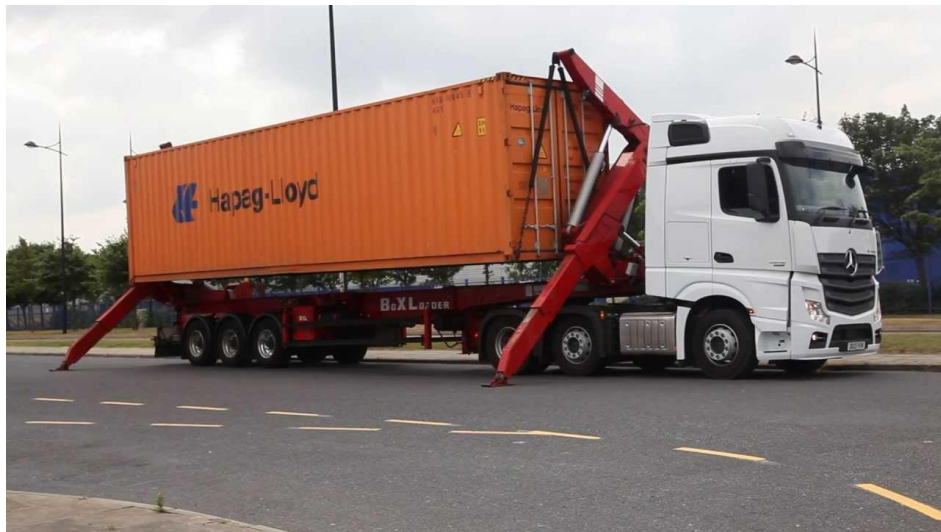
Obrázek 3. Nakládací mechanismus sidelifter G&S Transport trailer během provozu.
