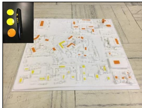
Obrázek 7: 3D tištěný model s nálepkami (RFID čipy). Převzato z [11].
