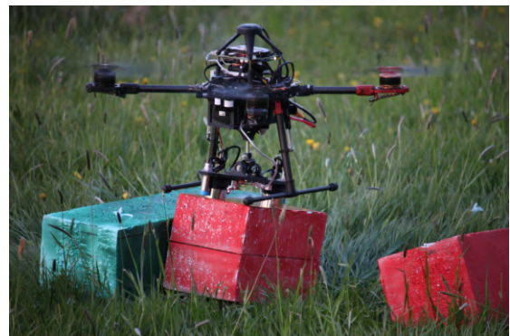
(d) UAV attempts to place a brick
