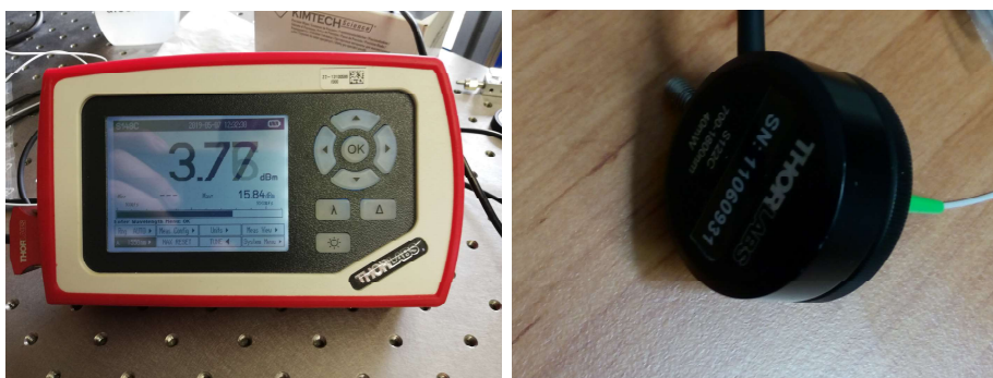
Obrázek 6.6: Měřič výkonu výstupního signálu PM100D (vlevo) a detektor s fotodiodou (v pravo)
