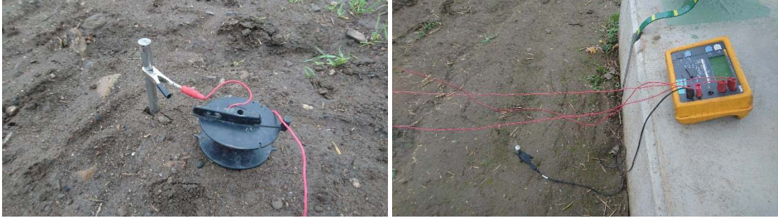
Obr. 4.4: Připojení elektrod k měřicímu zařízení v praxi
