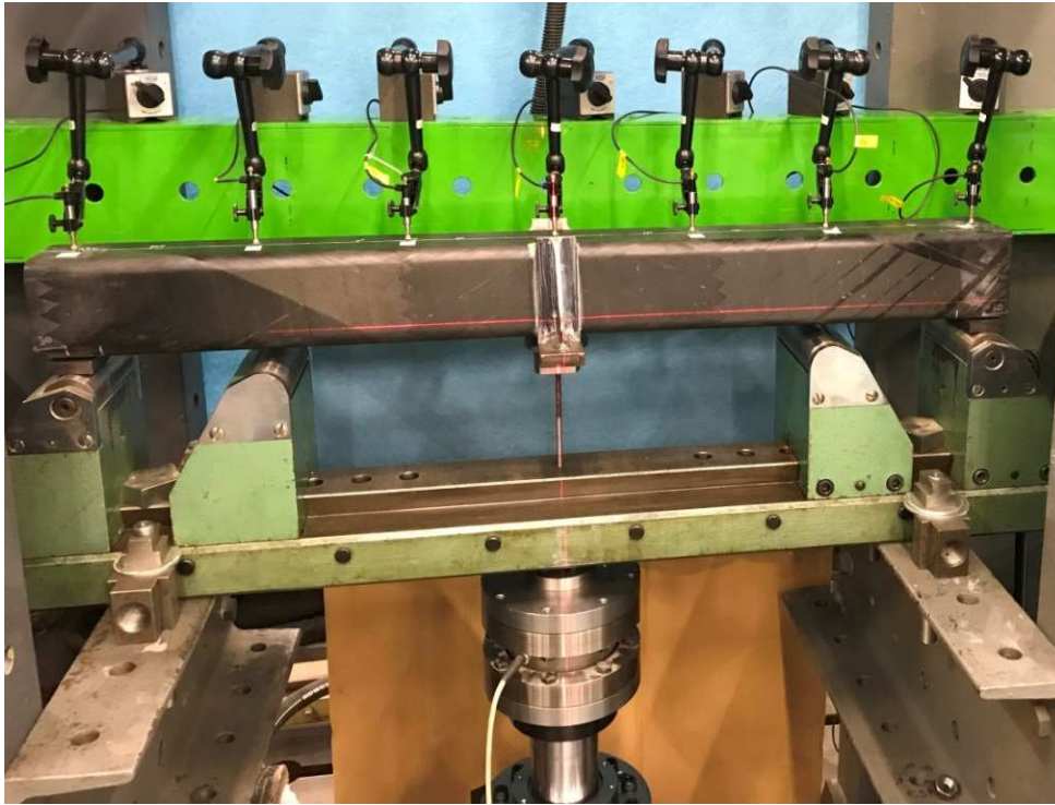
Obr. 8-12 Modifikovaná zkouška s výztuhami v oblasti podpor (940mm mezi podporami). Převzato z [D8].
