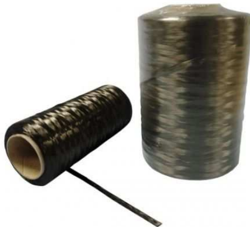
Obr. 2-10 Svazek uhlíkového vlákna namotaný na cívce. Převzato z [31].
