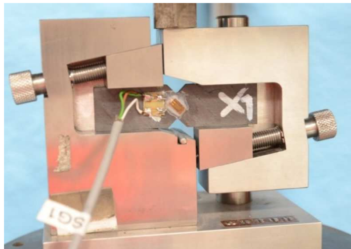
Obr. 7-5 Upnuté zkušební těleso v přípravku – smyk
