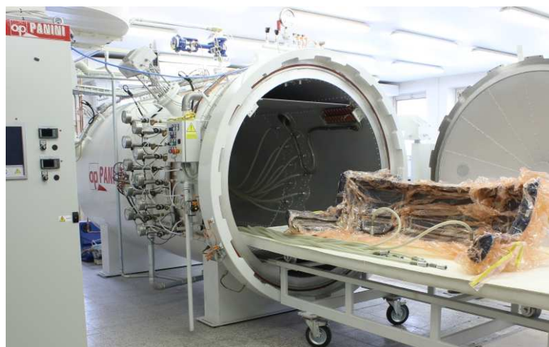
Obr. 2-21 Zakládání dílu do autoklávu. Přejato z [23].
