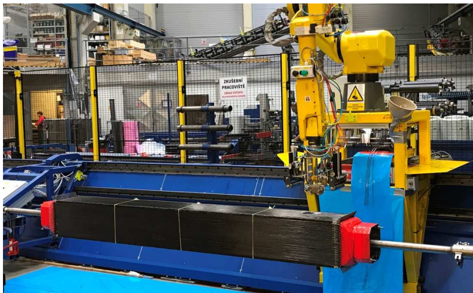
Obr. 1-1 Rozpracovaný nosník laserového plotru v robotickém navíjecím stroji firmy Compo Tech Plus s.r.o. Převzato z [E8].
