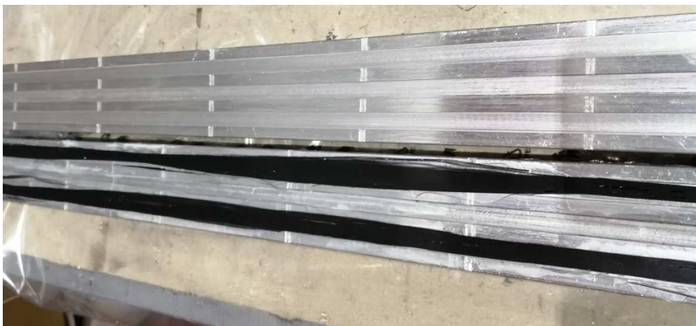
Obr. 7-7 Laminovaný pásek do formy – jeden svazek UHMC vláknů XN80-A2S
