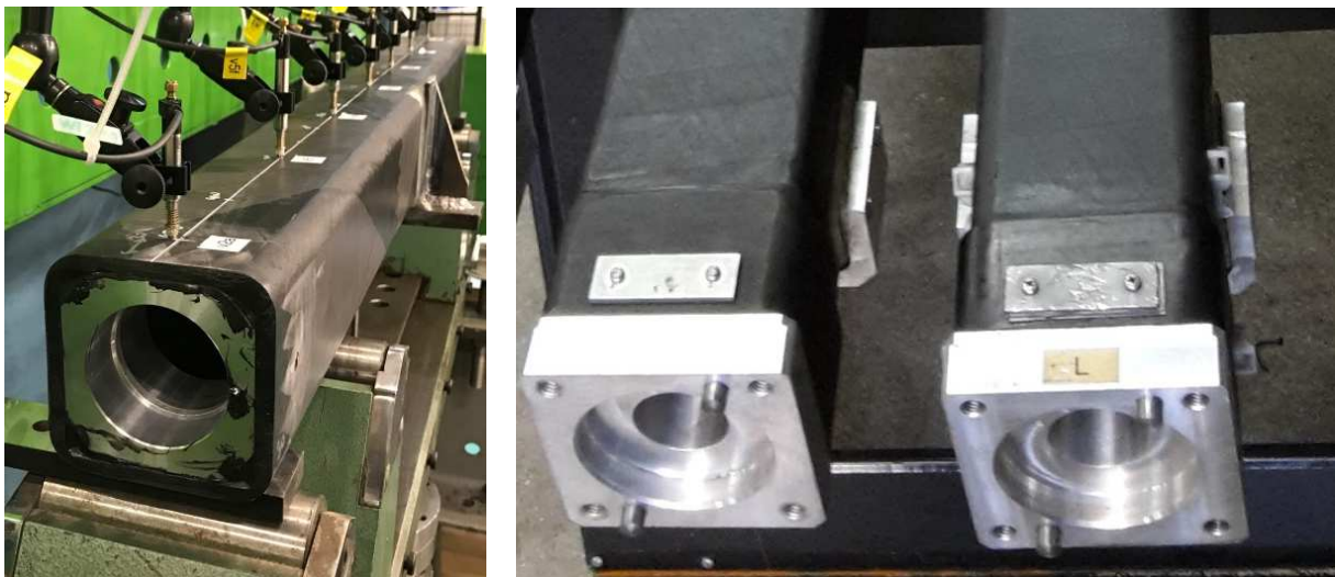
Obr. 8-11 Detail duralových vyztuží v místě podpory – a) zkušební těleso, b) reálná aplikace. Převzato z [D8].
