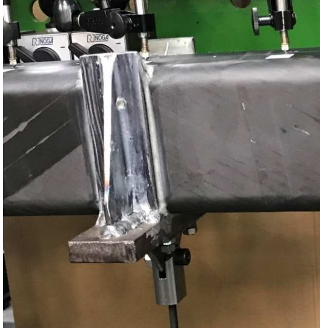
Obr. 8-4 Detail lepeného spoje zatěžujícího přípravku
