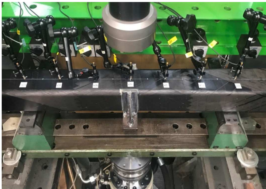
Obr. 8-5 Modifikovaná zkouška bez výztuh v oblasti podpor (600mm mezi podporami)
