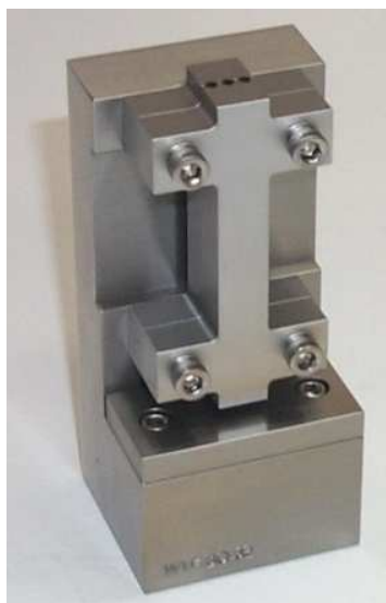
Obr. 7-3 Měřicí přípravek – tlak (vlevo) a tvar zkušební tělesa – tlak (vpravo). Převzato z [29].
