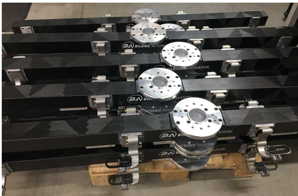
Obr. 5-8 Manipulátor z navíjených hybridních profilů pro lisovny od firmy Bilsing Automation GmbH
