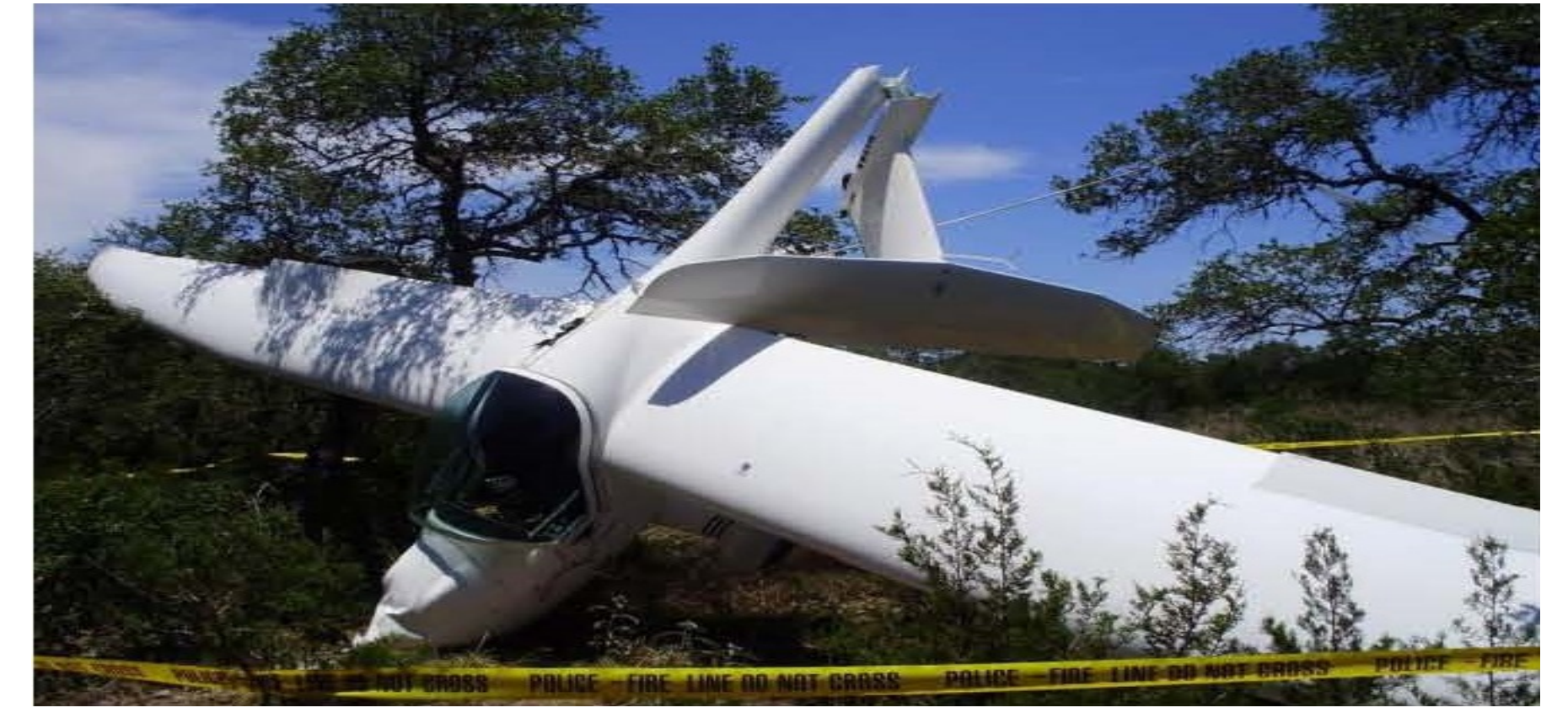
Nehoda způsobená flutterem T ocasních ploch letounu UFM-13 Lambda
