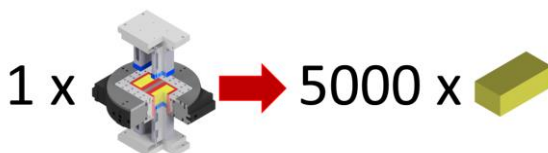
Obr. 3: Životnosti lisovacích nástrojů při použití dinasové lisovací směsi
