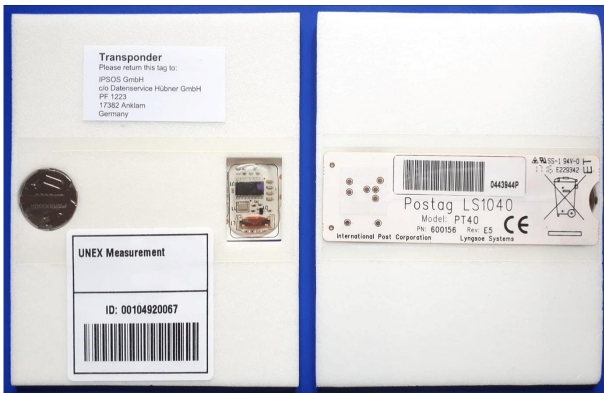
Obrázek 14: Fotografie tagu PT40 pro měření kvality v programu UNEX
