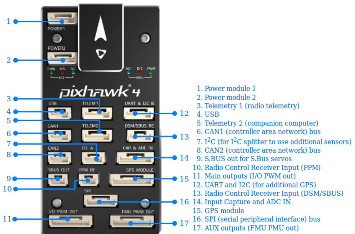
Obrázek 11 - popis jednotlivých vstupů / výstupů autopilota Pixhawk 4
