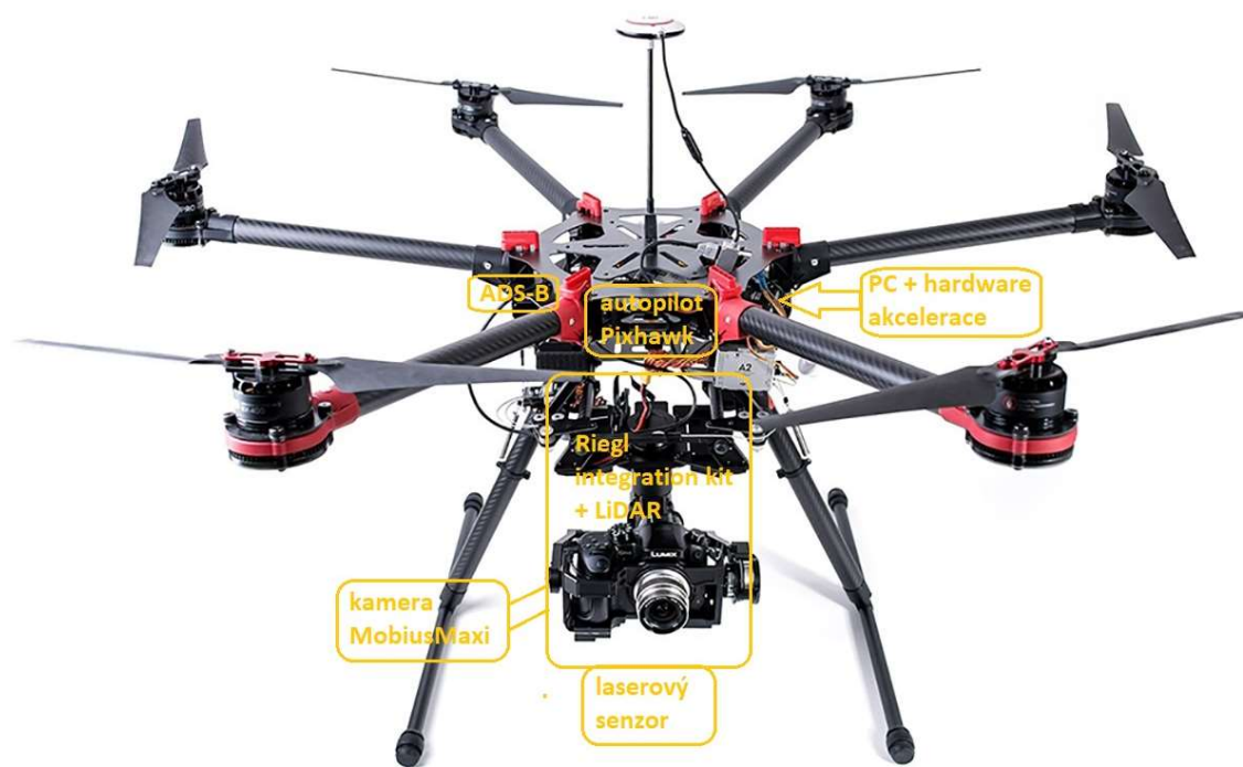
Obrázek 19 - DJI S900 Pro přední pohled a schéma umístění komponent systému [63]
