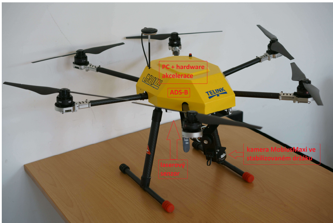
Obrázek 17 - Telink 720 Grid předo-boční pohled a schéma umístění komponent systému [59]
