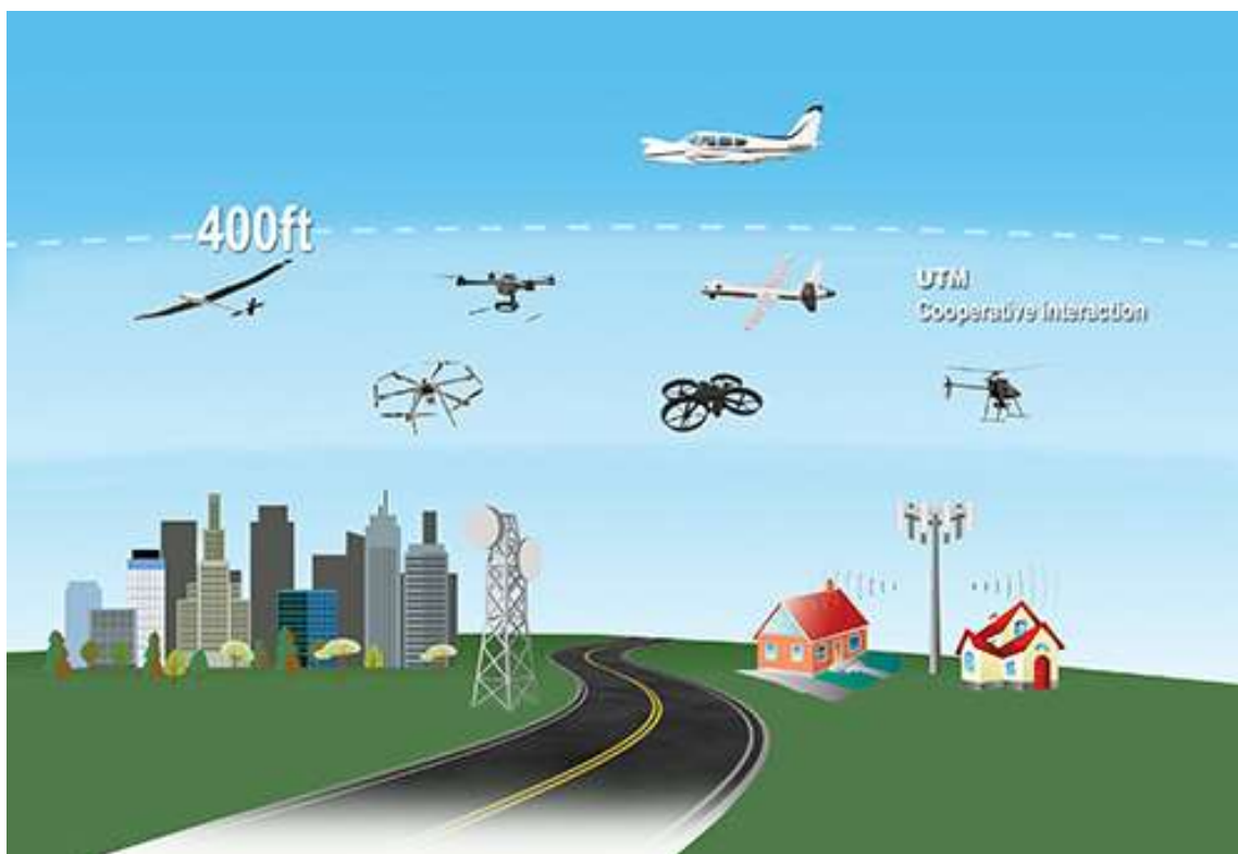
Obrázek 3 - pole působnosti konceptu UTM se týká bezpilotních systémů do 25 kg MTOM létajících do maximální výšky 400 ft AGL [20]
