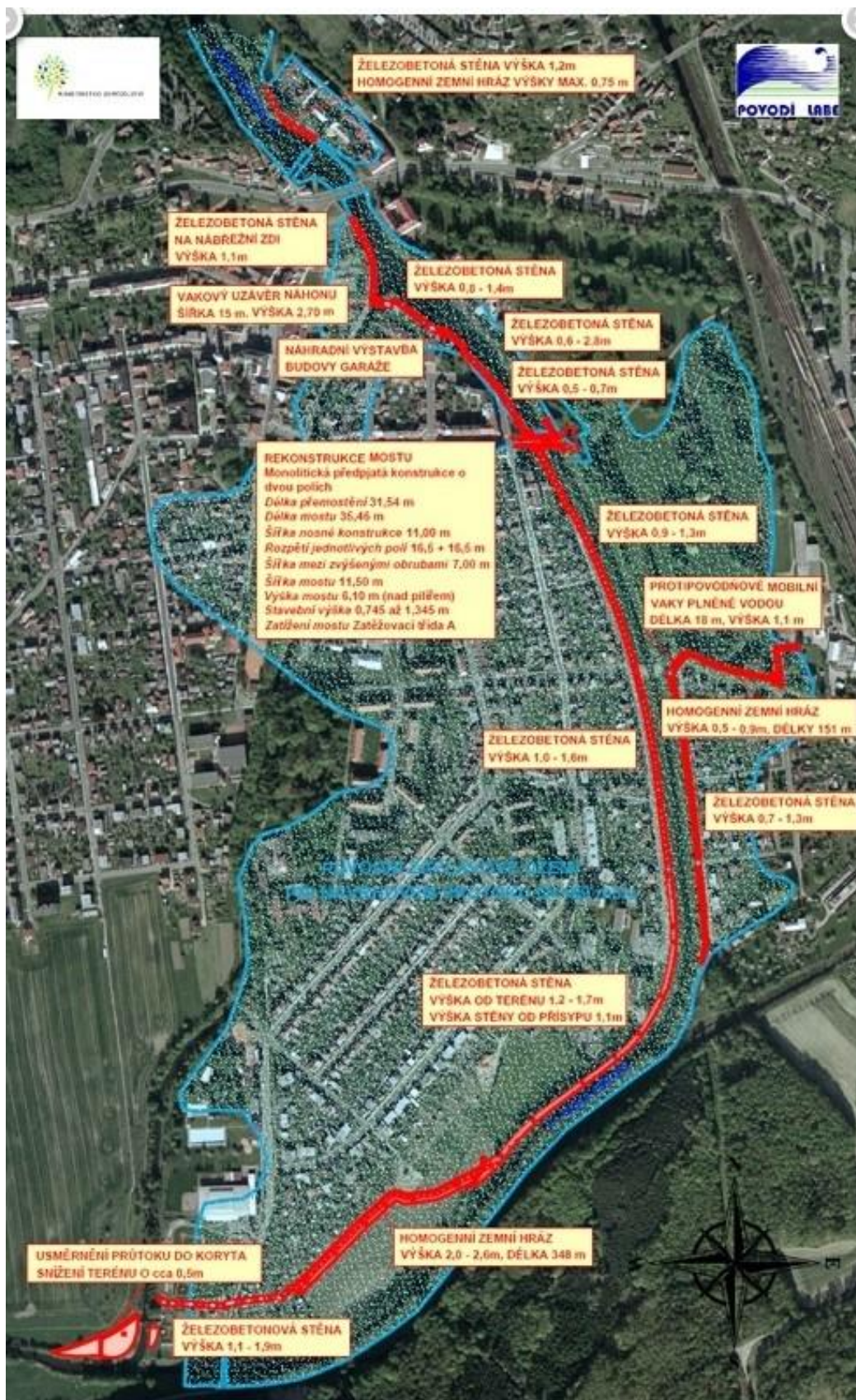
Obr. 1 - Situace povodňových opatření v Chocni. Zdroj: http://www.vodohospodarske-stavby.cz/clanek/protipovodnova-ochrana-mesta-chocne/
