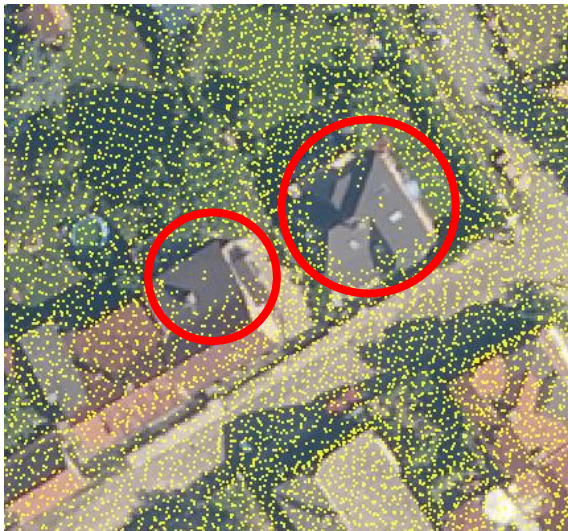
Obr. 25. Ortofoto, mračno bodů LLS (žluté body) a oblasti s řídkým výskytem bodů (červené kruhy) [1]
