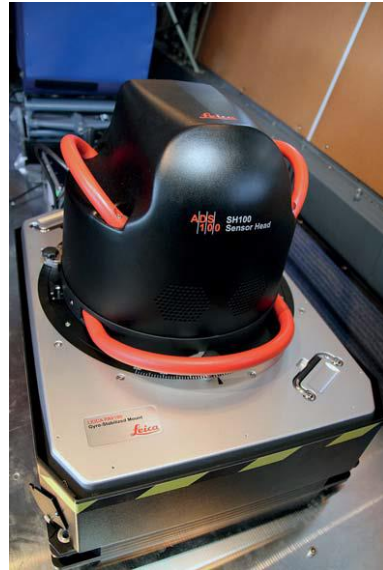
Obr. 14. Instalace leteckého snímkovacího systému Leica ADS100 [13]
