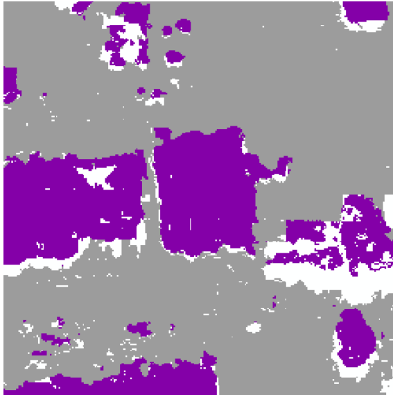
Obr. 69. Klasifikovaný NDMP z roku 2010, relativní výška: \leq 2 m (šedivě), > 2 m (fialově) [18]
