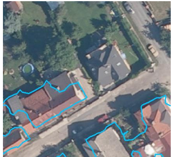
Obr. 26. Ortofoto a detekované obrysy budov z mračna bodů LLS (modré linie) [1]
