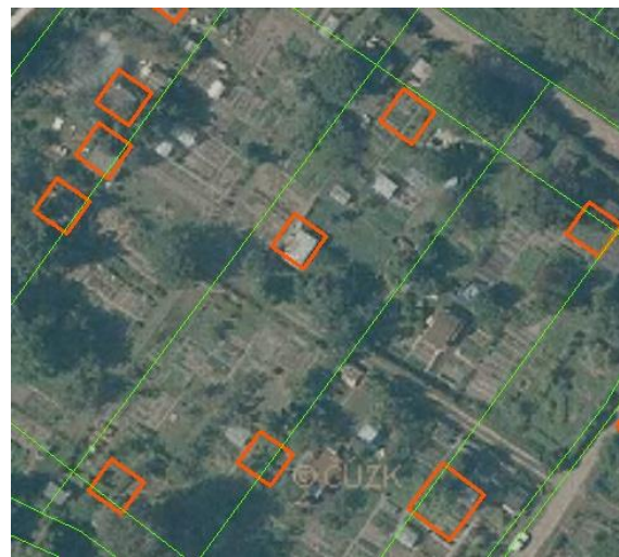
Obr. 39. Zákres budov v ZABAGED® v prostorech některých zahrádkářských kolonií vyjadřuje charakter území, přičemž katastrální mapa v tomto prostoru budovy vůbec neeviduje [34]
