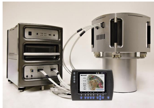
Obr. 5. Letecký snímkový systém (kamera, ovládací konzole a tzv. kontroler) [9]
