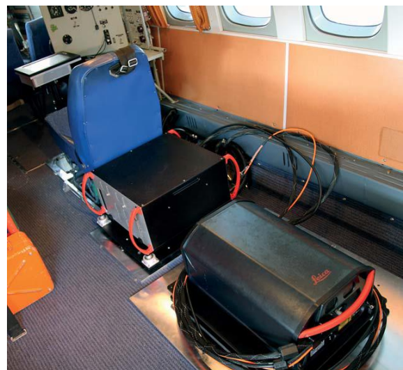
Obr. 10. Instalace leteckého laserového skenovacího systému Leica ALS80 [13]
