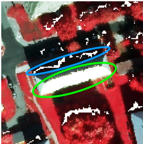
Obr. 33. Barevné infračervené mračno bodů z roku 2012 [11] podexponovaná místa (modře) a přexponovaná místa (zeleně)
