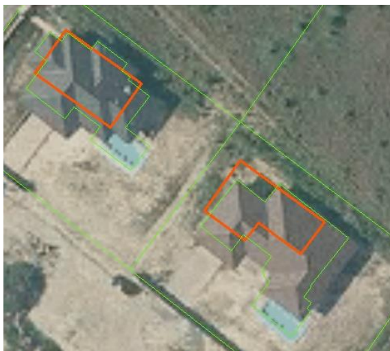
Obr. 38. Schematické vyjádření budov v ZABAGED® generalizovaných do měřítka 1:10 000 v porovnání s kresbou katastrální mapy nad ortofotem [34]
