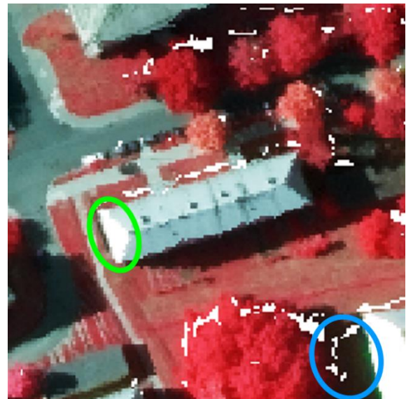
Obr. 34. Barevné infračervené mračno bodů z roku 2014 [11] podexponovaná místa (modře) a přexponovaná místa (zeleně)
