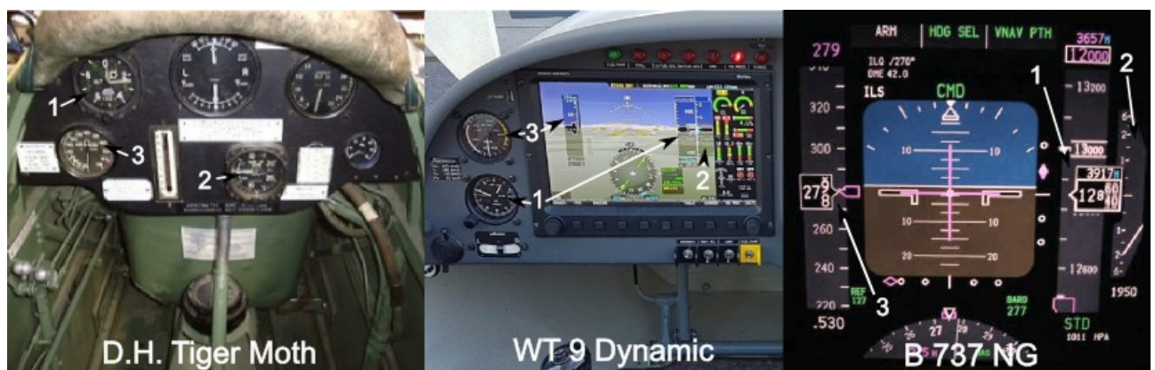
Obr. 1/1-Příklad umístění základní trojice přístrojů (1-výškoměr, 2-variometr, 3-rychloměr)
