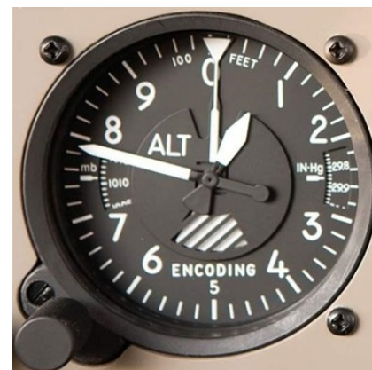
Obr. 3/4-Výškoměr s kódovaným výstupem výšky (~1970) [O10]
