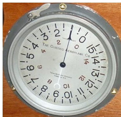
Obr. 3/1-Analogový baro-mechanický výškoměr (~1920) [07]
