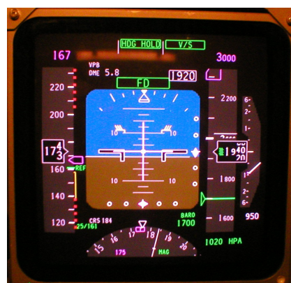
Obr. 3/3-EFIS systém letounu B747 (~1970) [O9]
