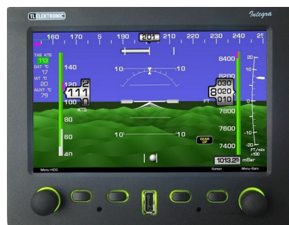
Obr. 3/5-EFIS systém TL Integra pro ultralehké letouny (~2005) [O11]
