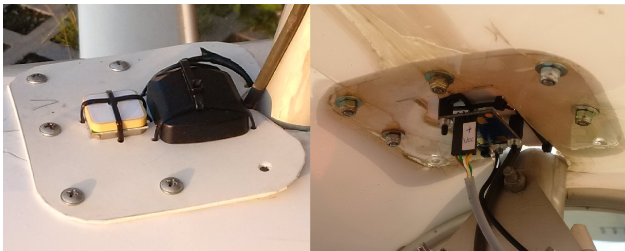
Obr. 7/3-Realizace pomocného modulu založeného na GPS přijímači
