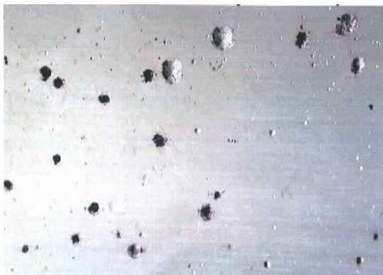
Obr. 5 Důlkové napadení vnitřního povrchu.
