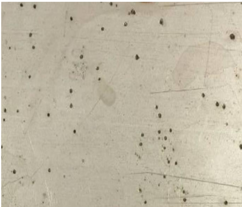
Obr. 1. Bodová koroze na povrchu [2].
