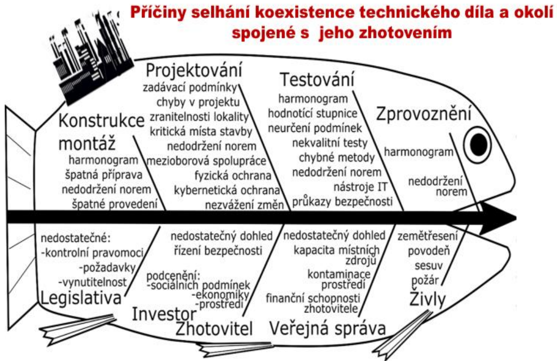
Obr. 4. Příčiny rizik při projektování, zhotovení a spouštění technických děl do provozu [36].
