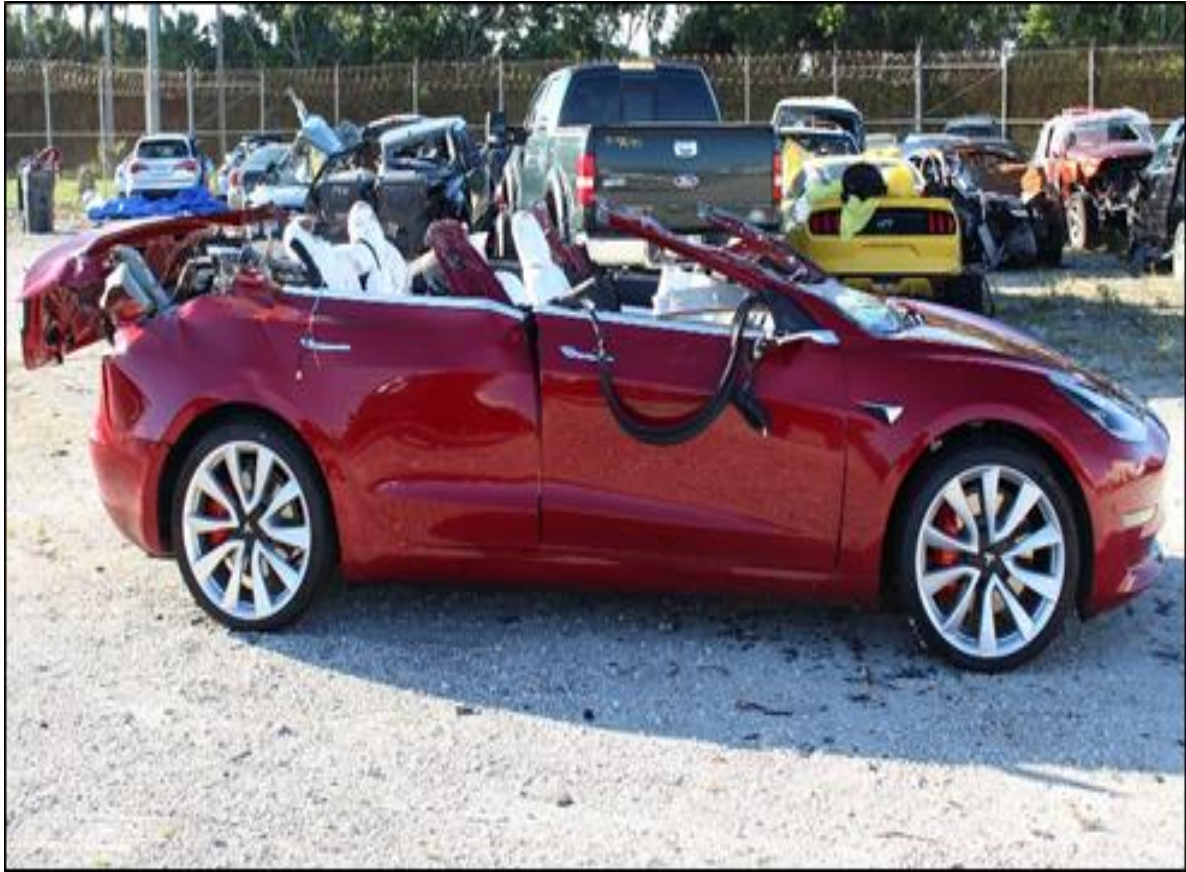
Obr. 1. Střet automobilu značky Tesla s návěsem při automatizaci úrovně 2; důsledek - úmrtí řidiče [16].
