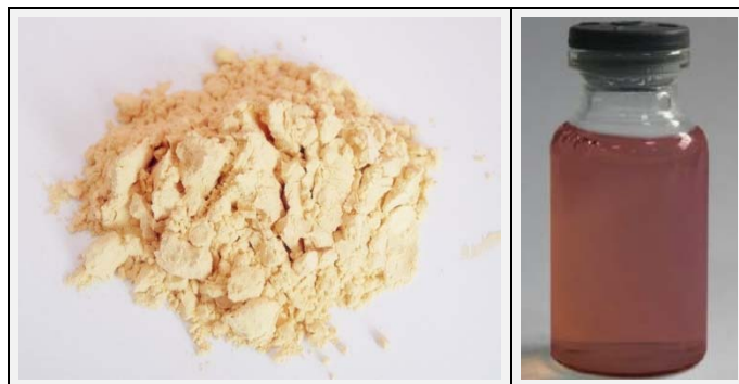
Obr. 39: a) Příklad prášku nanočástic zlata, b) Příklad roztoku nanočástic zlata
