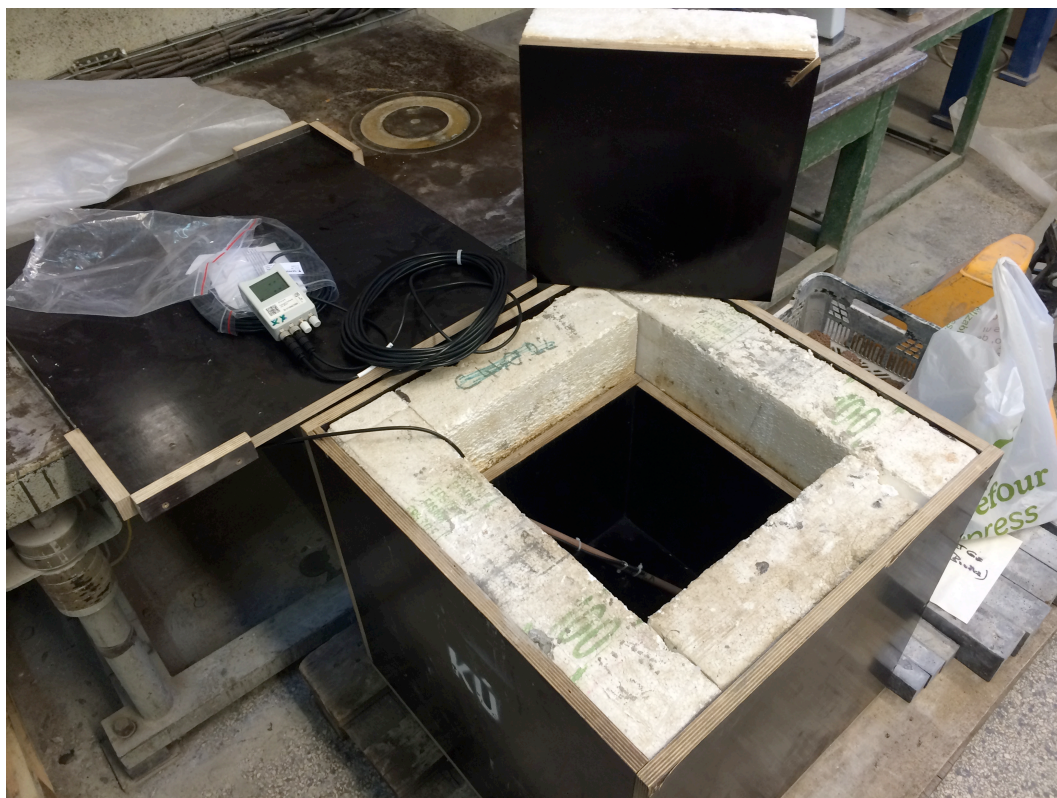
Obr 2: Pohled na připravenou formu izolované krychle o hraně 300 mm
