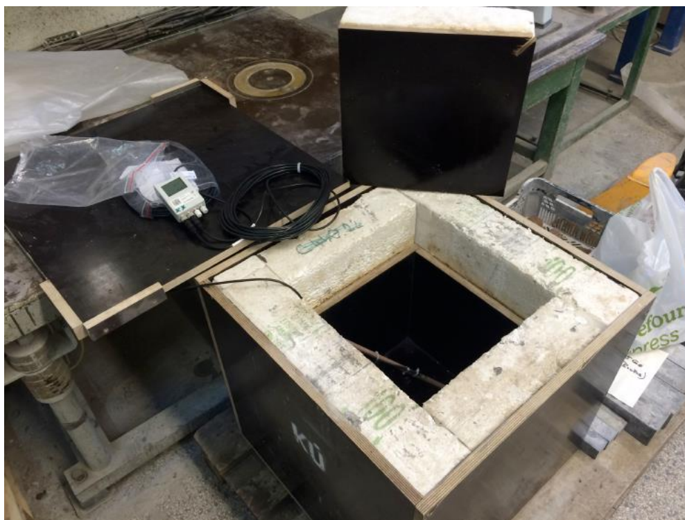
Obr. 70 Pohled na izolovanou formu tvaru krychle o hraně délky 300 mm (foto: David Čítek, K. Ú. ČVUT)
