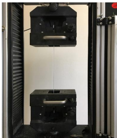
Obr. 46 Zkušební vzorek upnutý v trhačím zařízení těsně před zatěžováním
