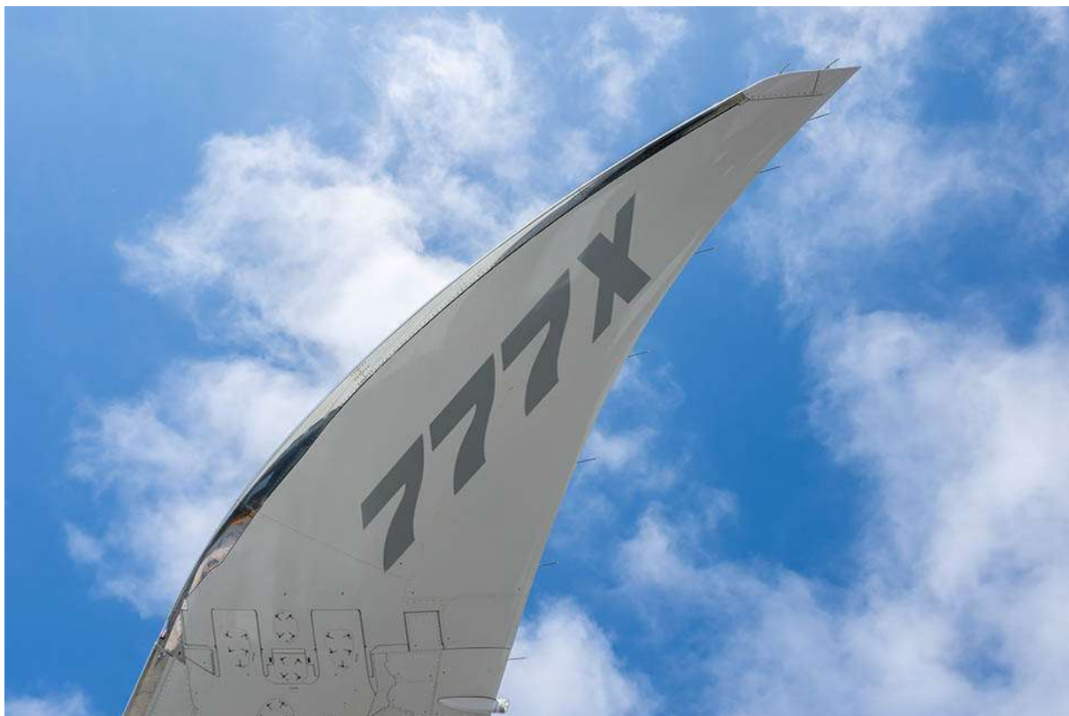
Obrázek 8: Detail na sklápěcí konec křídla B777X [34]
