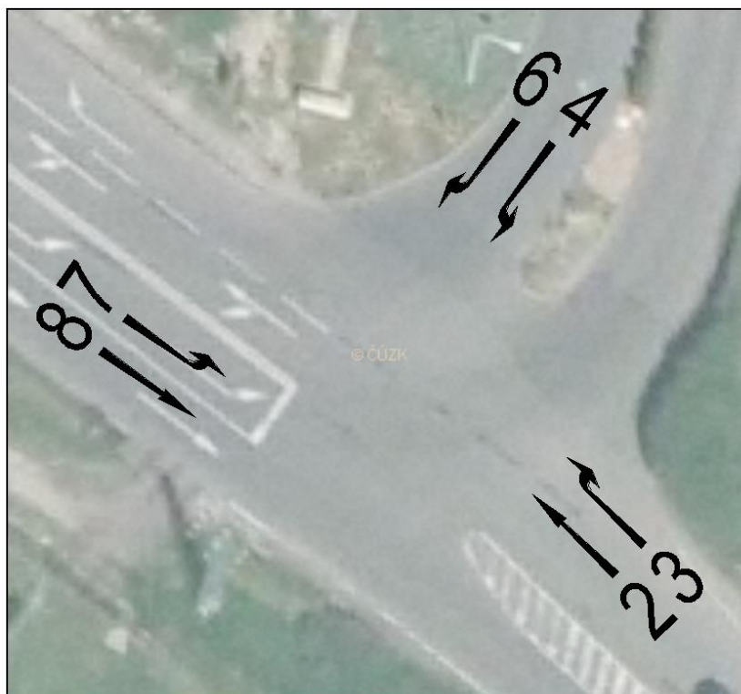
Obrázek 17: Rozložení směrů na odbočce k čerpací stanici
