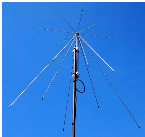
Obrázek 16: Disccone anténa AOR DA-3200 (zdroj: převzato z [9]).
