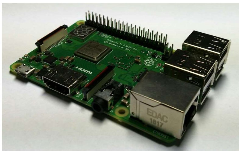
Obrázek 19: Jednočipový mini počítač Raspberry Pi 3 B+ (zdroj: autorův archiv)
