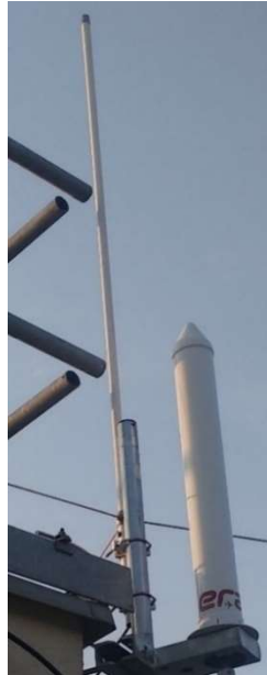
Obrázek 15: Anténa Diamond D-777 - na obrázku anténa vlevo (zdroj: autorův archiv).
