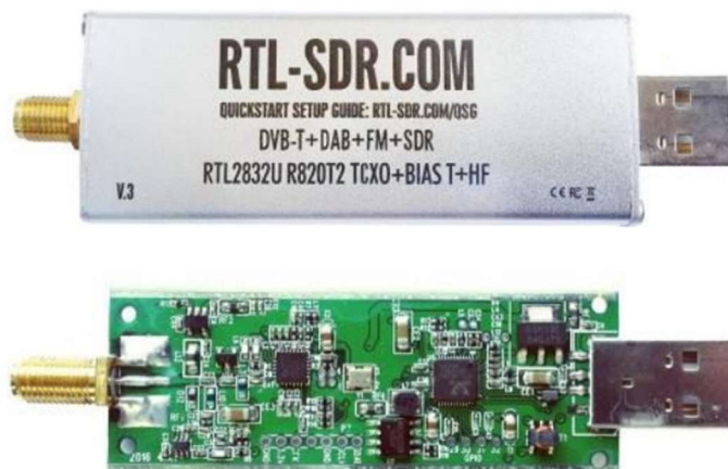
Obrázek 14: Upravený, běžně dostupný DVB-T tuner na RTL-SDR V3 (zdroj: převzato z [19]).
