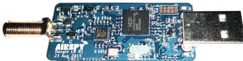
Obrázek 10: Airspy mini bez kovového krytu (zdroj: převzato z [3]).
