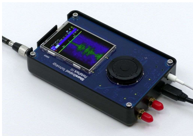
Obrázek 12: Rozšíření Portapack na přijímač HackRF One (zdroj: převzato z [28]).
