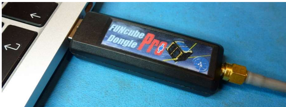
Obrázek 7: Přijímač FUN Cube Dongle Pro+ při propojení s PC a anténou (zdroj: převzato z [11]).
