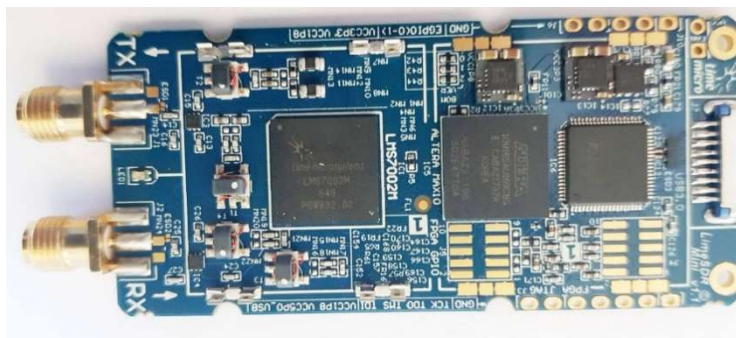
Obrázek 13: LimeSDR mini – pohled na vnitřní komponenty (zdroj: převzato z [24]).
