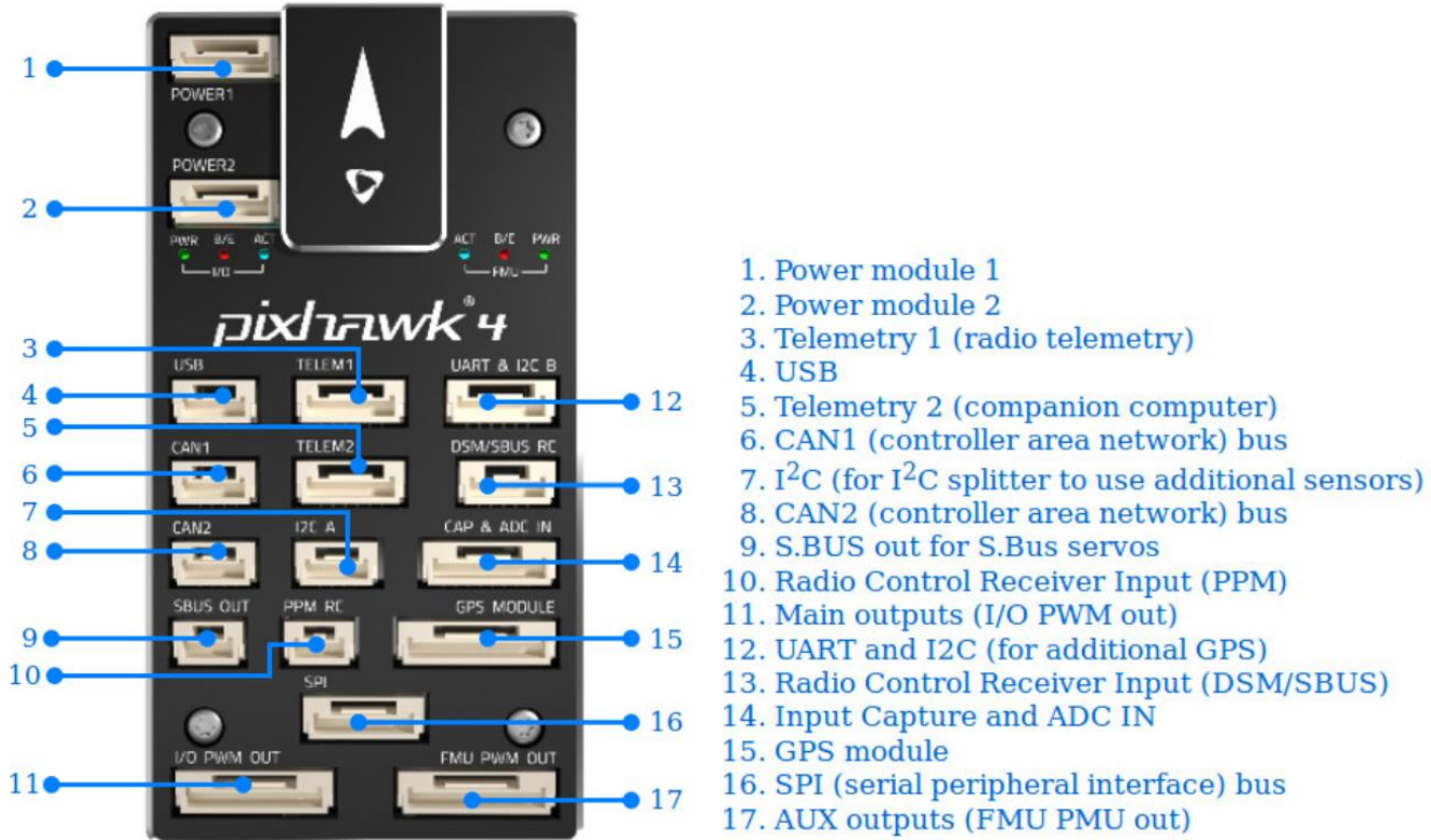
Obrázek 16 - schéma vstupů / výstupů autopilota Pixhawk 4 [38]
