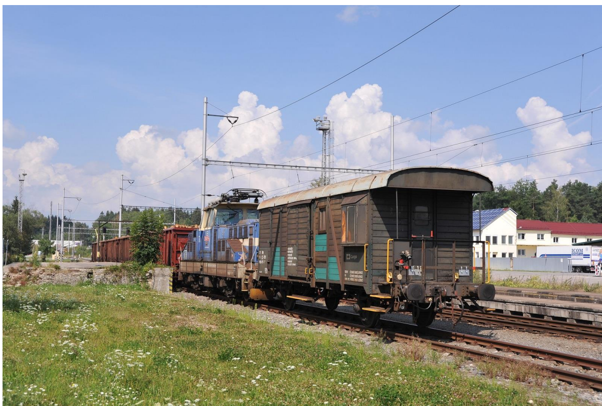
Obrázek 5. Lokomotiva řady 210 s bateriovým vozem při posunu mimo trolejové vedení [Foto autor 2018]
