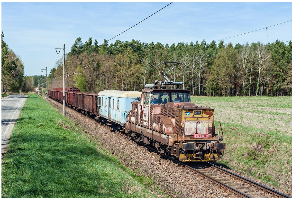
Obrázek 6. Typický výkon lokomotivy řady 210 s bateriovým vozem – manipulační vlak na jednokolejně elektrifikované trati; zde 210.046 nedaleko Veselí nad Lužnicí [Foto autor 2018]
