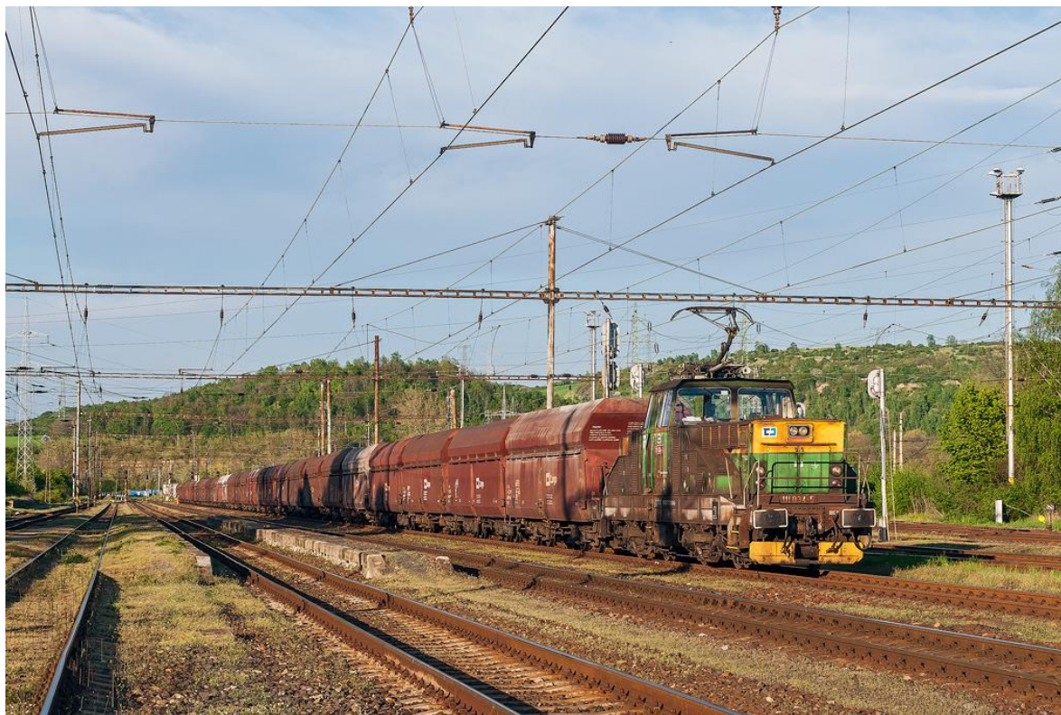
Obrázek 9. Ideální výkon pro elektrickou či dvouzdrojovou lokomotivu – posun a sestavování souprav, případně jejich doprava na krátkou vzdálenost; na snímku lokomotiva řady 111 ve stanicí Světec [Foto autor 2016]
