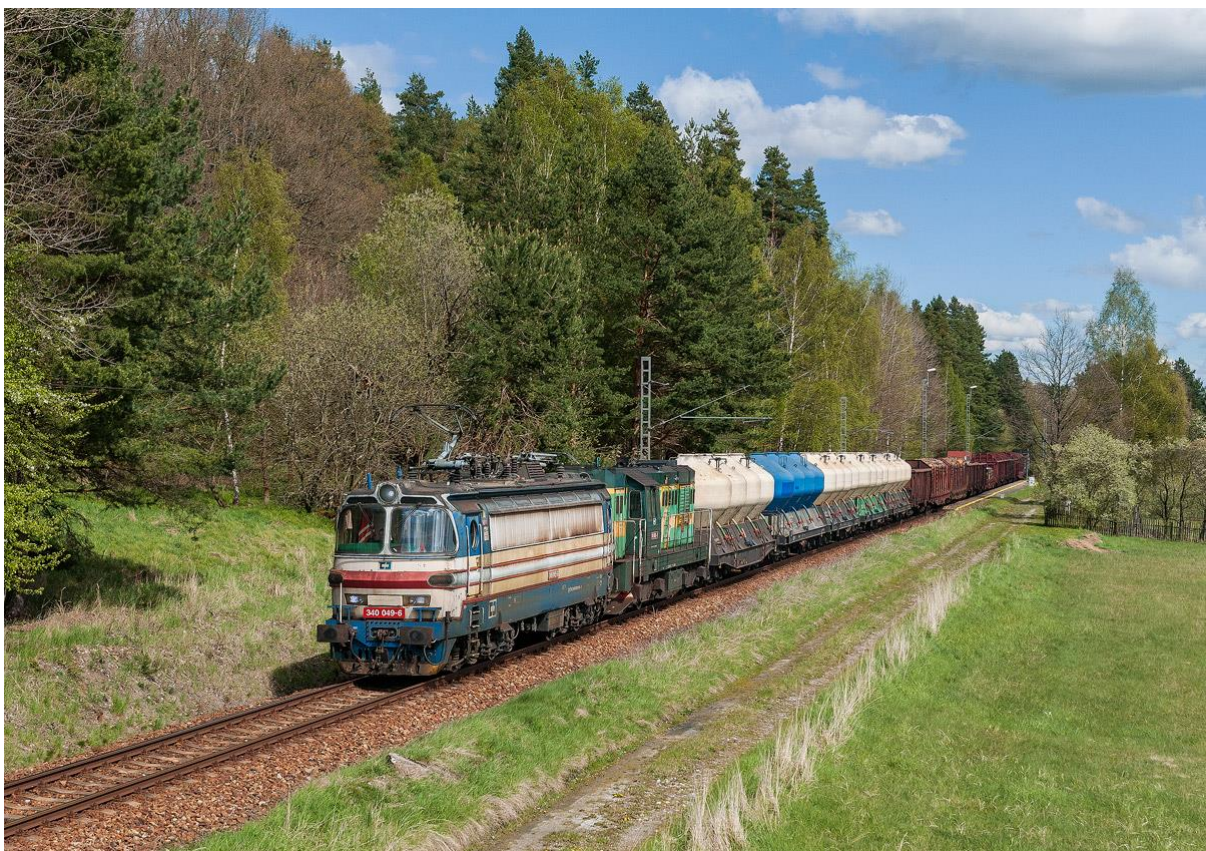
Obrázek 4. Nasazení elektrické a dieselové lokomotivy na jednom vlaku, zde v podobě kombinace řad 340 a 743 mezi Českými Velenicemi a Českými Budějovicemi. Stroj nezávislé trakce provádí obsluhu tratě České Velenice – Třeboň a vleček ve stanicích Borovany a Nové Hrady. [Foto autor 2017]
