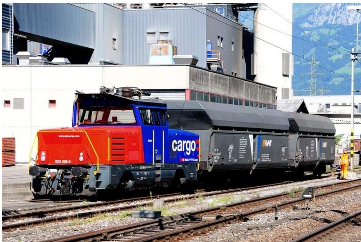
Obrázek 2. Lokomotiva Eem 923 SBB Cargo při posunu v režimu nezávislé trakce [Zdroj: Railcolor.net]
