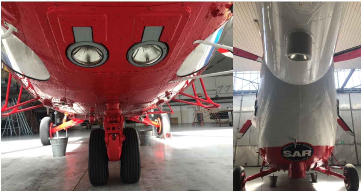
Obrázek 15 - Další světelná zařízení vrtulníku W - 3A Sokol [autor]
