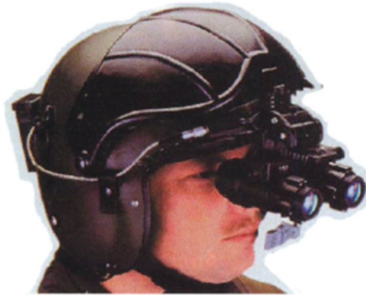
Obrázek 10 - NVG připevněné na letecké přilbě [15]
