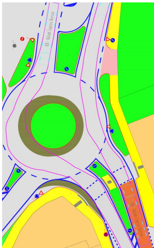
Obrázek 18. Ověření průjezdnosti 2. varianty OK vozidlem NSN I
