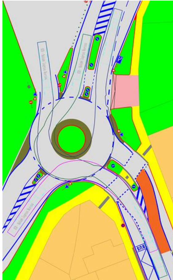
Obrázek 13. Ověření průjezdnosti 1. varianty OK vozidlem NSN I
