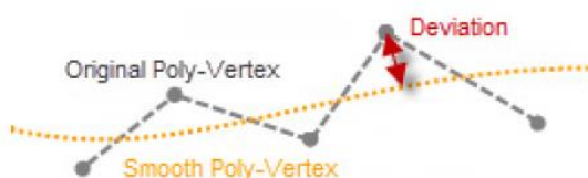
Obrázek 35 - Princip "přípustné odchylky" [2]
