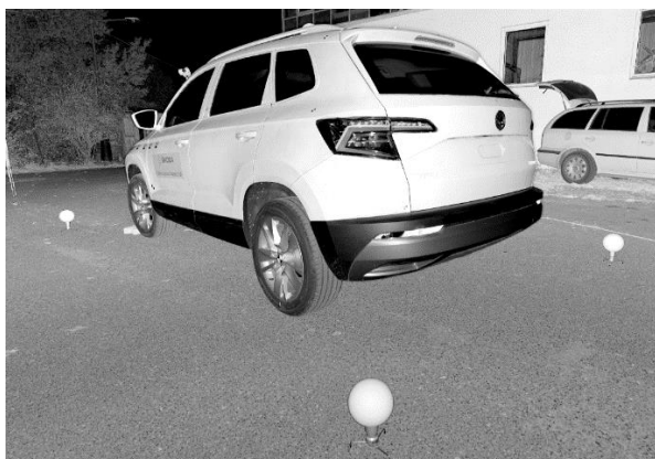
Obrázek 10 - Zorné pole stanoviště 2 s vyznačenými vřícovacími body
