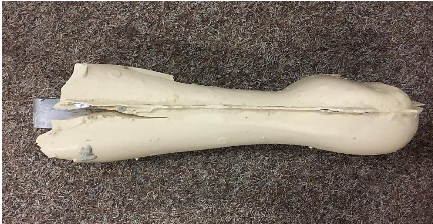
Obrázek 40 - Roztržení jednoho z odlitků předloktí při odformování
