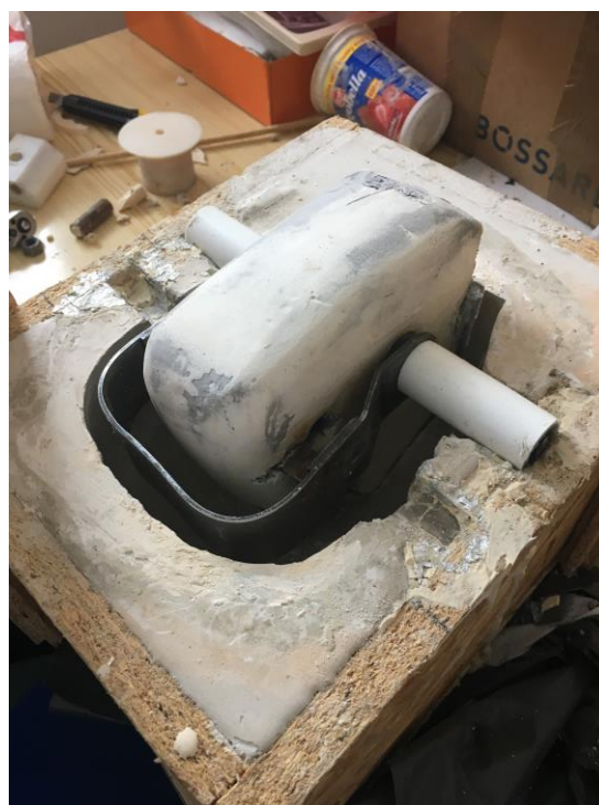
Obrázek 30 - Příprava formy pro hlavu
