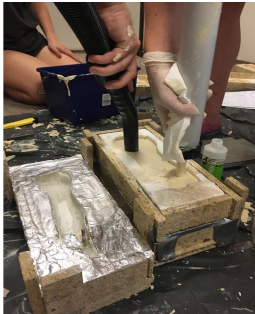
Obrázek 34 - Vtlačování směsi tlakovou pistolí za vytvoření podtlaku vysavačem
