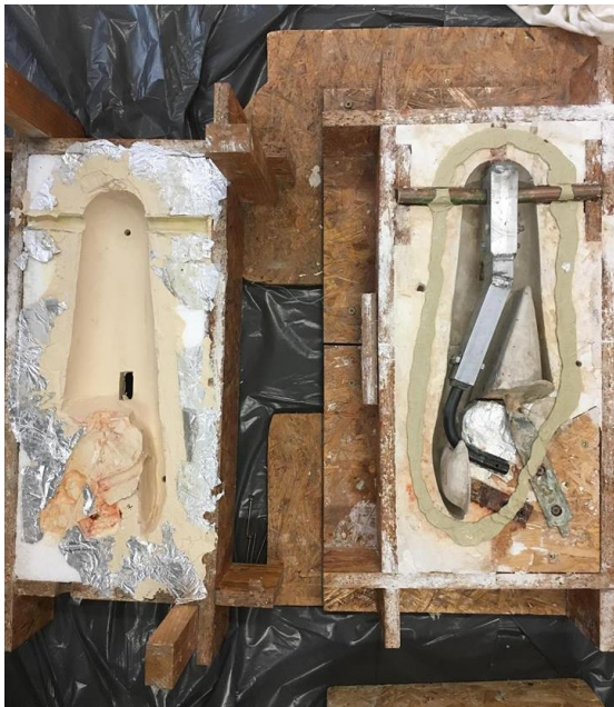
Obrázek 33 - Utěsnění forem pomocí sklenářského tmelu
