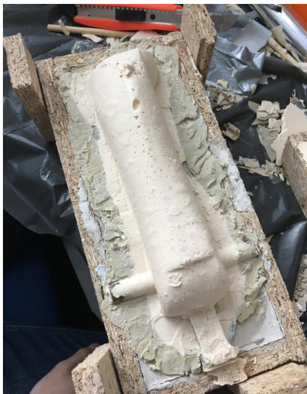
Obrázek 37 - Vzduchové kapsy vytvořené na horní polovině pažní kosti
