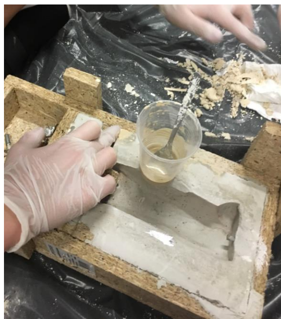
Obrázek 27 - Sádrová rekonstrukce spodní poloviny formy
