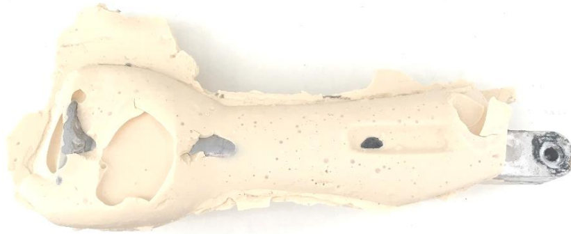
Obrázek 38 - Nezdařilé odlití jednoho z předloktí
