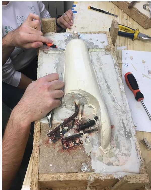
Obrázek 39 - Problematické vyjímání odlitku stehna ze sádrové poloviny formy
