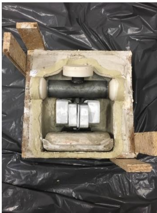
Obrázek 29 - Příprava formy pro hrudník
