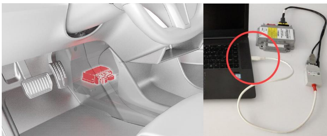
Obrázek 27: Umístění RCM v Modelu S (vlevo) a připojení D2M (vpravo) [83]
