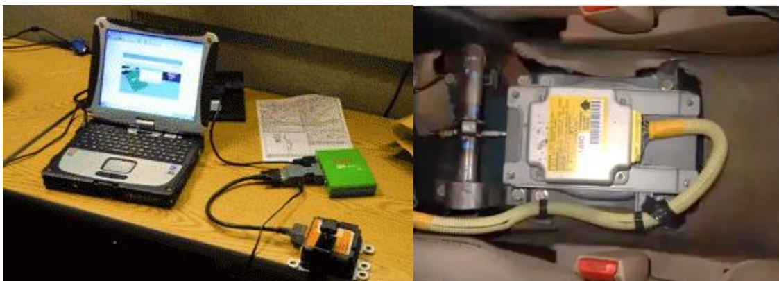
Obrázek 18: D2M připojení, modul vyjmut z vozidla (vlevo), modul ve vozidle (vpravo) [70]
