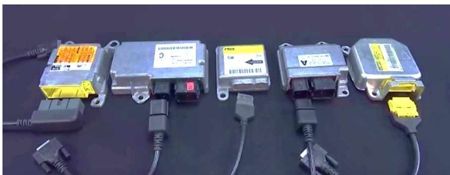
Obrázek 19: Různá provedení ACM a kompatibilní konektory [70]
