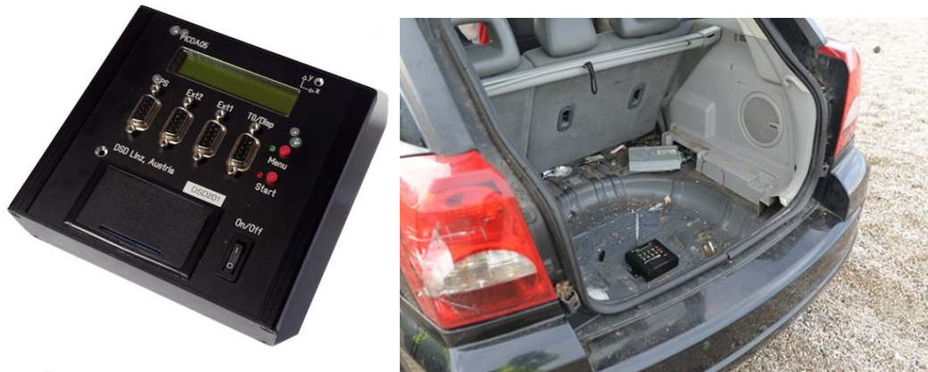
Obrázek 37: Zařízení PicDAQ a jeho upevnění ve vozidle [25]
