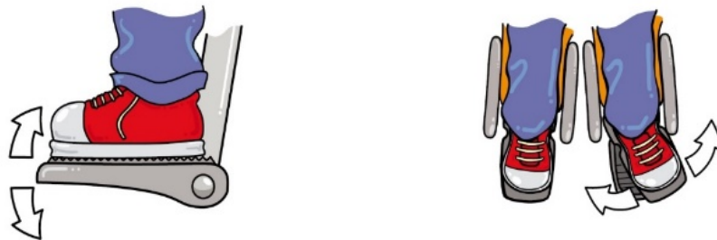
Obr. 6.1.3-2: Plantární a dorsální flexe (vlevo) a vytočení podnožky vně a dovnitř (vpravo) [3]
