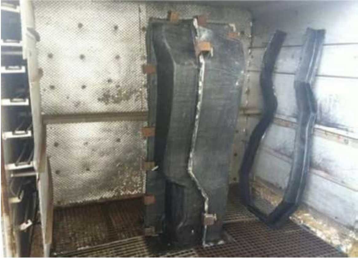
Obr. 13.: Formy monocoque vozu FS.05 a FS.06 v peci před dotvrzením [20]
