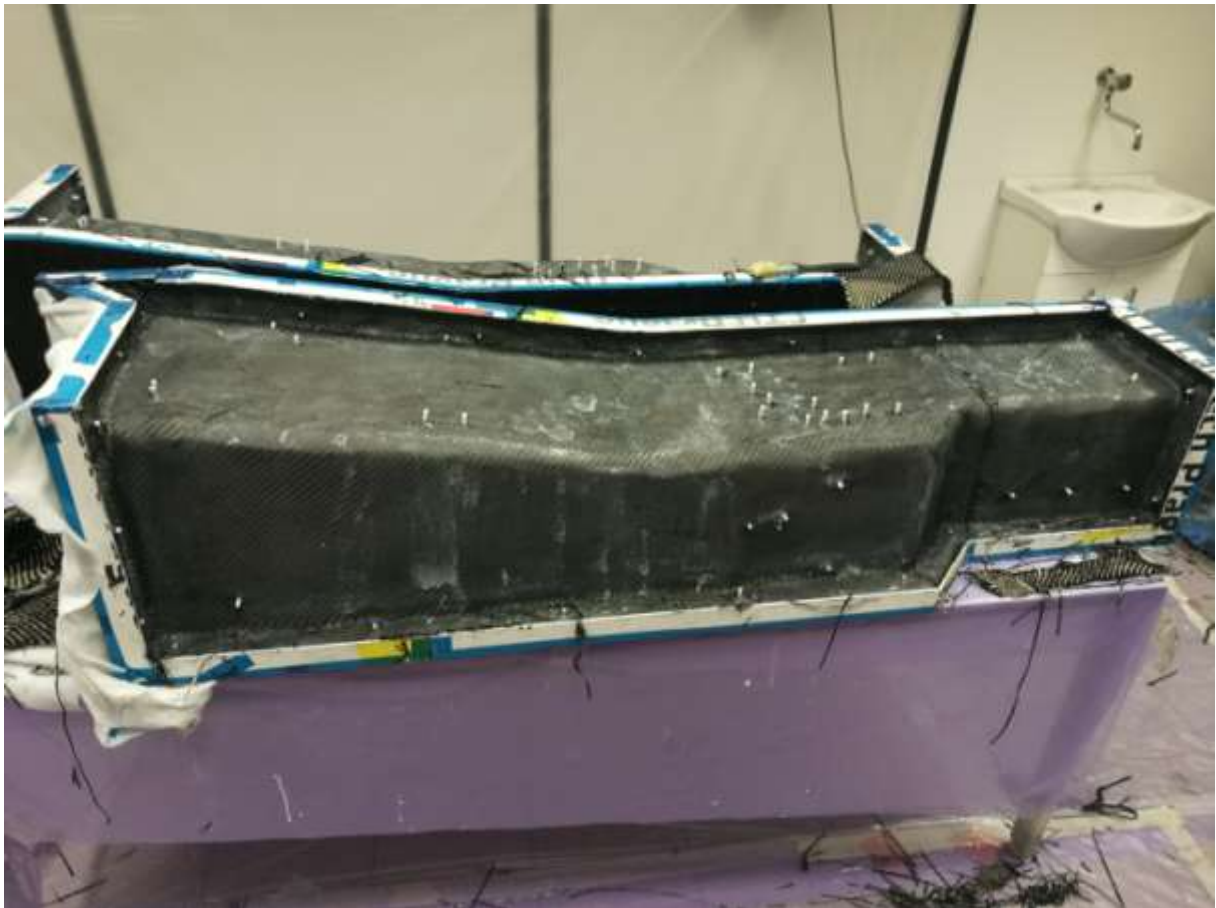
Obr. 32.: Vrstva uhlíkové tkaniny s gramáží 600g/m 2 prosycená pryskyřicí
