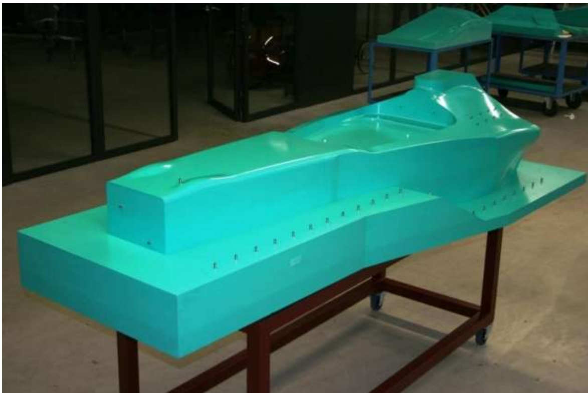
Obr. 9.: Formy na monocoque z materiálu RAKU-TOOL® [13]
