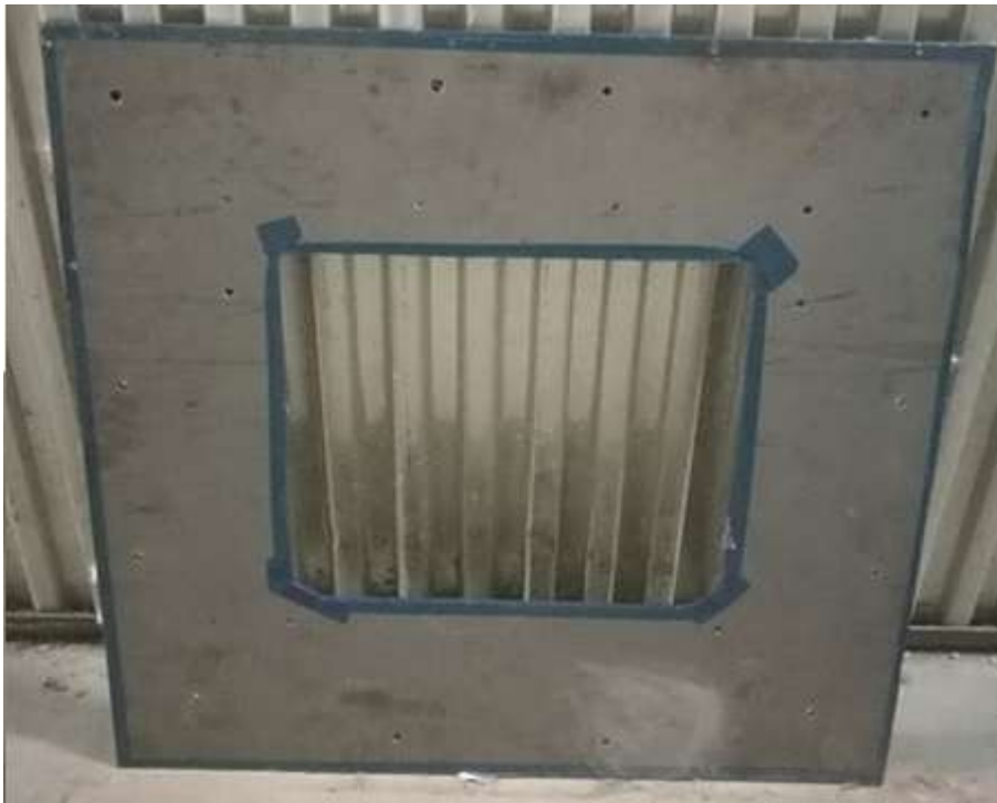
Obr. 37.: Přední ocelová deska forem
