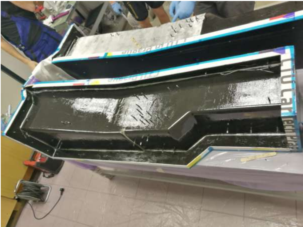
Obr. 30.: Makety forem s naneseným gelcoatem
