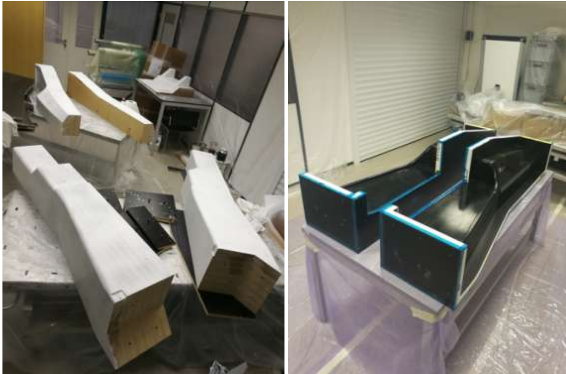
Obr. 29.: Makety s naneseným plničem pórů Obr. 28.: Makety nalakované a naseparované
