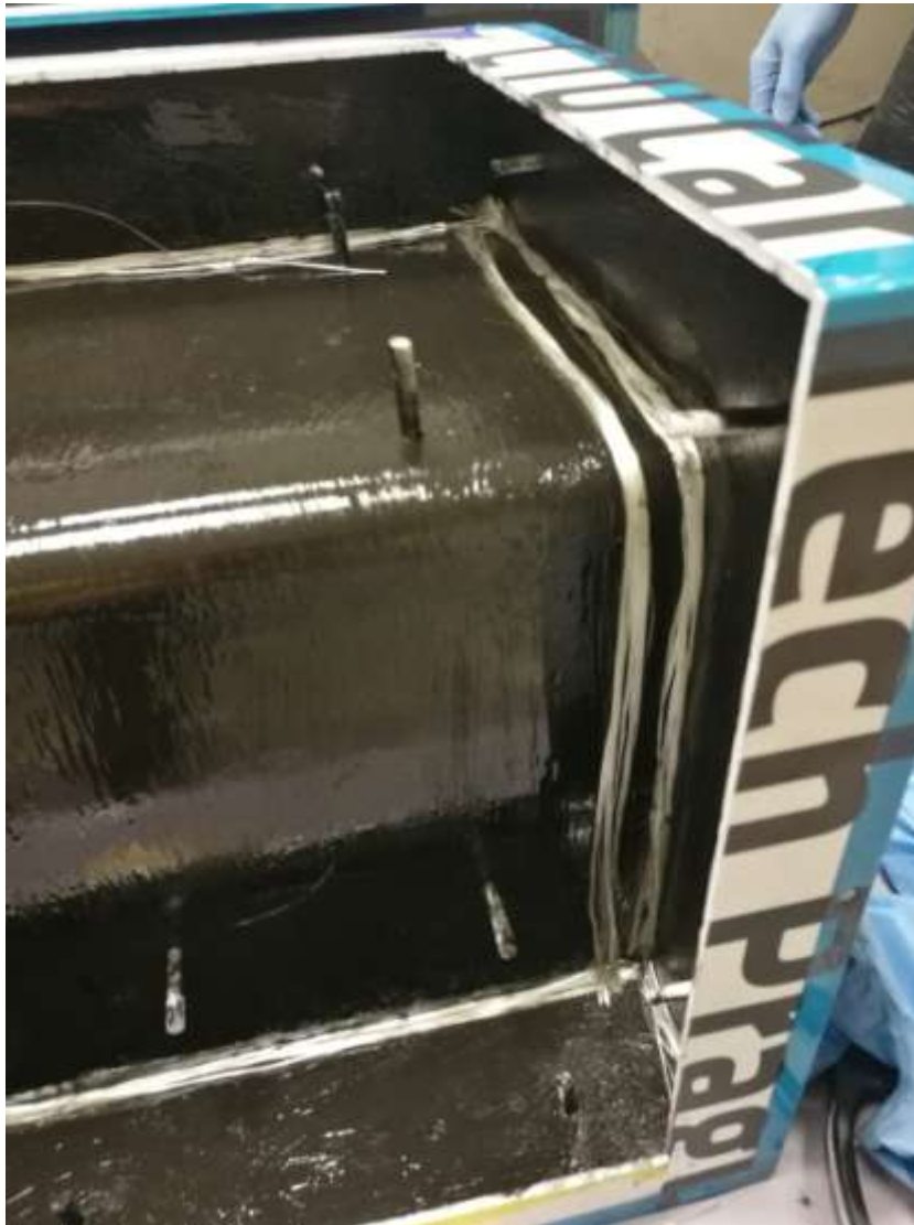
Obr. 31.: Vložené skelný rovingy v rozích maket
