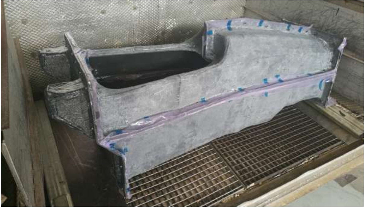
Obr. 38.: Formy umístěné v peci před dotvrzením
