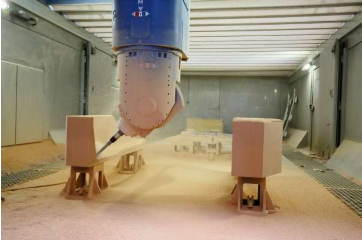
Obr. 10.: Obrábění maket na formy [5]
