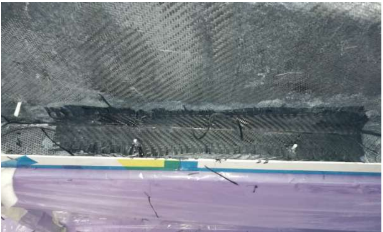
Obr. 42.: Opravený kus formy novou uhlíkovou tkaninou prosycenou pryskyřicí
