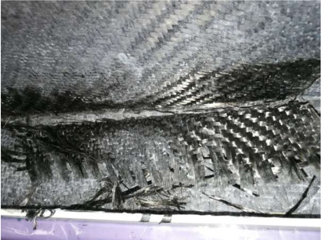
Obr. 41.: Odstraněný kus delaminované uhlíkové tkaniny
