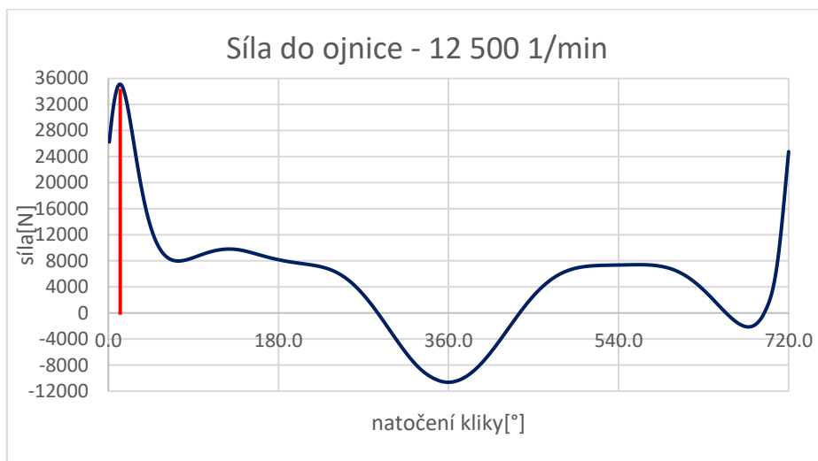
Obr. 64 Síla do ojnice při 12 500 1/min
