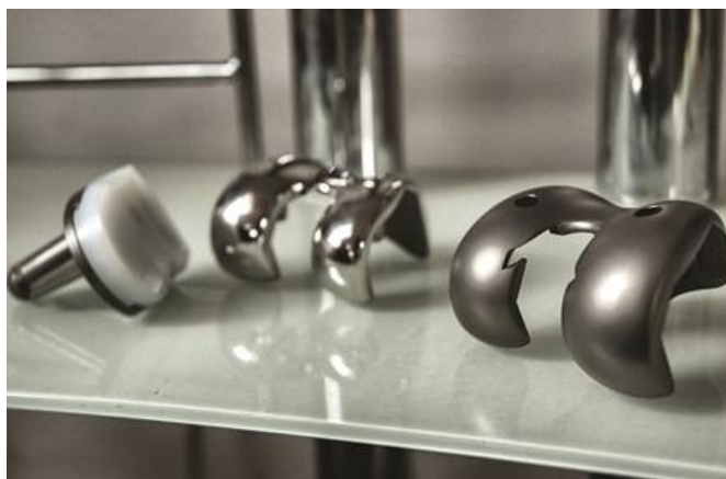
Obrázek 7 Ukázka implantátu kolenního kloubu. Vpředu zkušební šablona implantátu vyrobená aditivní technologií, vzadu leštěná kloubní náhrada z odlitku. [23]
