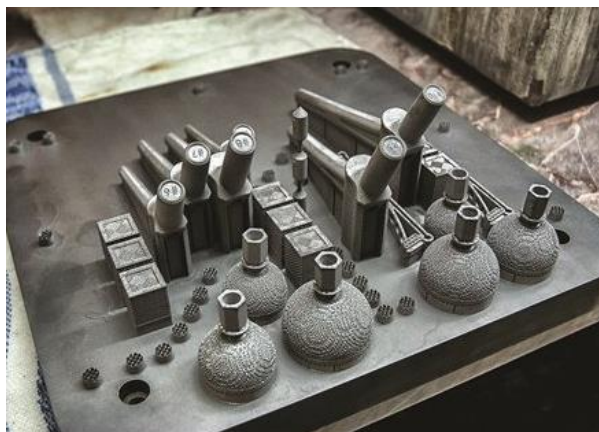
Obrázek 6 Kyčelní jamky a další implantáty pro veterinu vyrobené pomocí 3D tisku [23]
