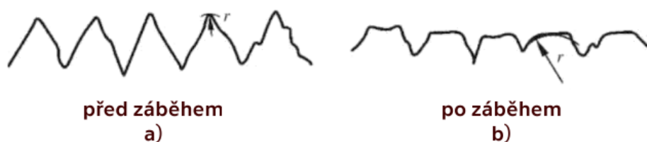
Obrázek 5 Topografie povrchu před a po záběhu [19]
