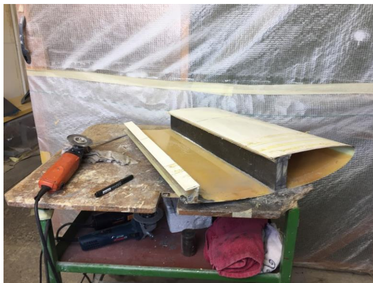
Obrázek 16 – Řezání zkušebních vzorků sendvičového potahu křídla
