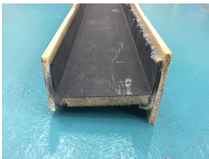
Obrázek 7 – struktura nosníku tvaru C v nástavci křídla
