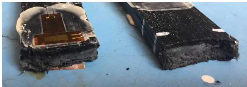
Obrázek 24 – detail na lom vzorku 008, vzorek je položen horní stranou na stůl
