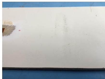
Obrázek 26 – detail prohnutí sendviče pod příčnickem zatěžujícího stroje, méně zatěžovaná strana
